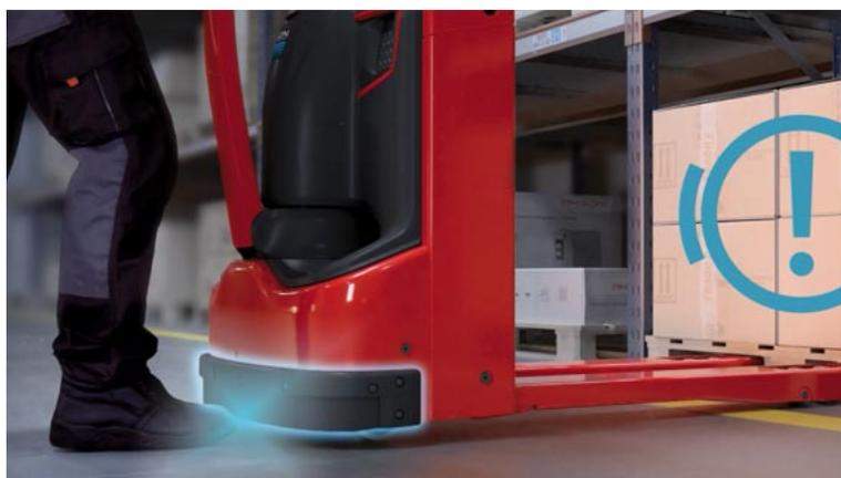
Bei Berührung der aktiven Fußschutzleiste stoppt das MFFZ umgehend und verhindert Fuß- oder Knöchelverletzungen. Mit der STOP&GO-Funktion springt der Mitgänger zusätzlich ein Stück zurück, um sich von dem Fuß des Bediener zu entfernen.
