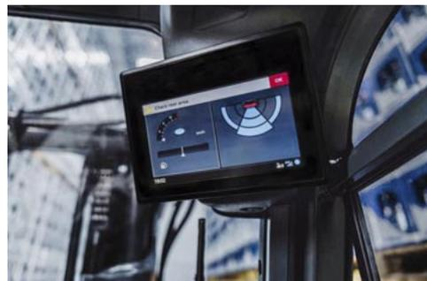
Zusätzlich zur automatischen Geschwindigkeitsreduzierung und Anfahrverhinderung im Gefahrenfall erhält der Fahrer eine Warnung auf dem Display, welche den Abstand und die Position des detektierten Objektes oder der detektierten Person anzeigt. Dies wird durch die farbliche Markierung des jeweiligen Bereiches hinter dem Stapler erreicht.
