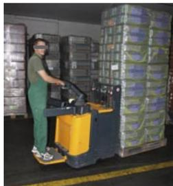
Bild oben: Mitgänger-FFZ mit klappbarer Standplattform
