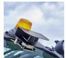
Einfache Nachrüstung für Bestandsfahrzeuge und Flotten – unabhängig von Hersteller oder Baujahr! Das Foto oben zeigt einen am Heck eines FFZ montierten LiDAR-Sensor mit Wetterschutzhaube.
