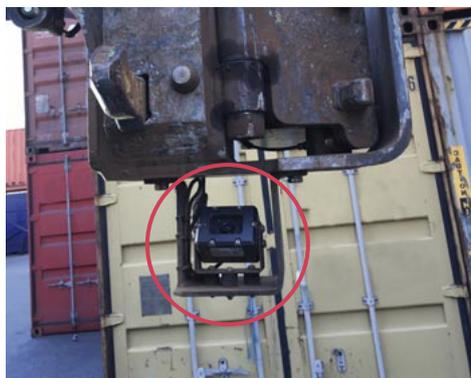
Das Verwenden von KMS ermöglicht bzw. erleichtert dem Fahrer den Blick in schwer einsehbare Bereiche.
