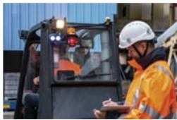
Das am Gabelstapler montierte System erkennt Personen, warnt den Fahrer und vermeidet Fehlalarme.
