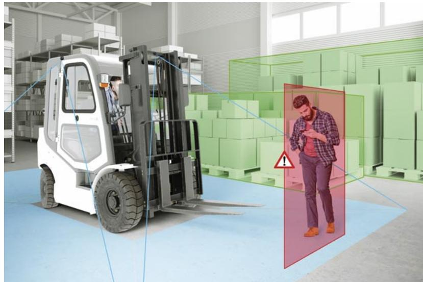
Die am FFZ montierten und damit bekannten Kamerapositionen werden herangezogen, um eine ausreichend genaue Entfernungseinschätzung abzugeben, die eine rechtzeitige Warnung möglich macht. Voraussetzung dafür ist ein einmaliger Kalibriervorgang bei Montage der Kameras.
