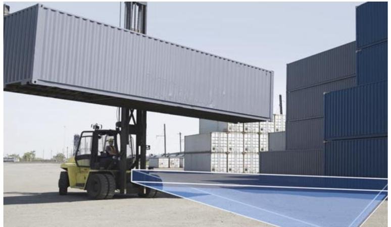
Anwendungsbeispiel: Das im Frontbereich montierte Radarsystem detektiert den Fahrweg des Containerstaplers. In der Detektionszone befindliche Objekte werden von den Sensoren erkannt.
