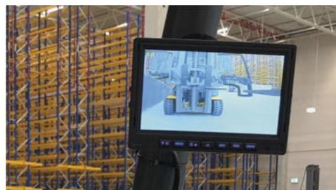
**Abhilfe:** Durch einen Blick auf den Monitor kann der Fahrer die Situation im rückwärtigen Arbeitsbereich einsehen.
