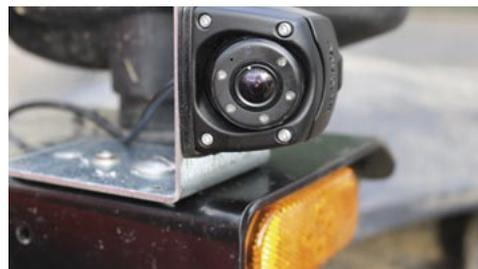
**Abhilfe:** Nachträglich montierte Seitenbereichskamera an einem Teleskopstapler zur Einsicht in den Gefahrenbereich.
