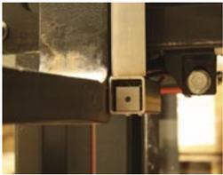
Die Kamera mit Pinhole-Objektiv ist gut geschützt vor Stößen und Beschädigungen durch Gitterboxen oder Paletten. Dabei bietet sie freie Sicht auf beide Gabelzinken und erleichtert das Ein- und Auslagern von Waren.
