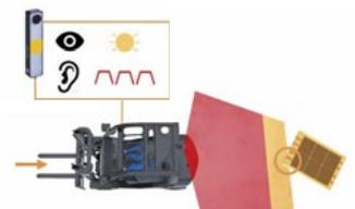
Objektdetektion innerhalb des Warnfeldes: Die Signalleuchte leuchtet gelb, zudem wird ein Warnton aktiviert.
