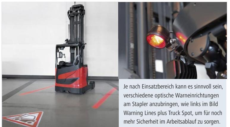
Je nach Einsatzbereich kann es sinnvoll sein, verschiedene optische Warneinrichtungen am Stapler anzubringen, wie links im Bild Warning Lines plus Truck Spot, um für noch mehr Sicherheit im Arbeitsablauf zu sorgen.
