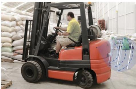
Zwei am Heck montierte Ultraschallsensoren (Foto oben) detektieren den rückwärtigen Nahbereich des Gabelstaplers. In der Detektionszone befindliche Objekte werden von den Sensoren erkannt (Grafik Draufsicht Gabelstapler von oben).
