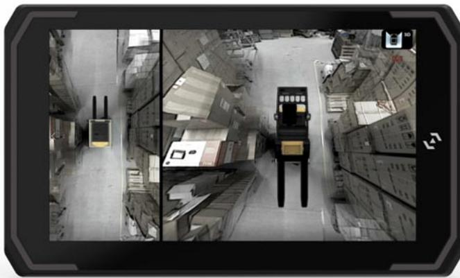
Monitor Darstellung von 4 Kameras, die ein 360° Live-Bild erzeugen. Der Bediener hat ein vollständiges, rundum kontrollierbares Sichtfeld für schnelles, präzises und stressfreies Arbeiten, Fahren und Manövrieren.
