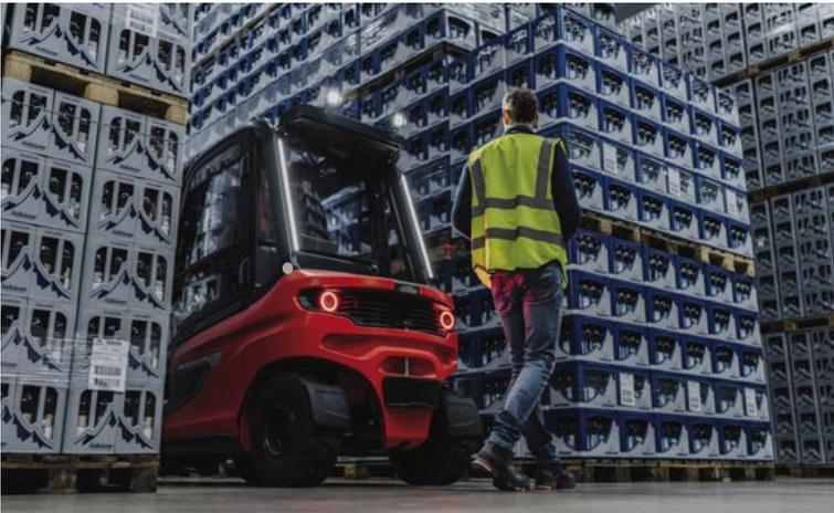
Sicherheit in der Gefahrensituation: Enge Gänge, hohe Ware und dunkle Lichtverhältnisse im Lager erschweren die Sicht des Fahrers. Das Assistenzsystem detektiert den Kollegen hinter dem Stapler und bremst das Fahrzeug automatisch ab.
