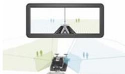
Je nach Anforderung kann zur Sicht auf die Gefahrenbereiche eine senkrechte oder waagerechte Ausrichtung des Displays gewählt werden – mit einer Bildaufteilung im Verhältnis 1:1 (siehe Abbildung oben) oder 2:3 (siehe Abbildung links).
