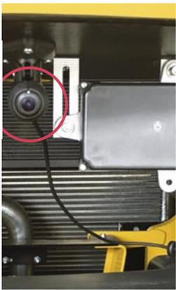
Radarsensor in Verbindung mit einer Rückfahrkamera
