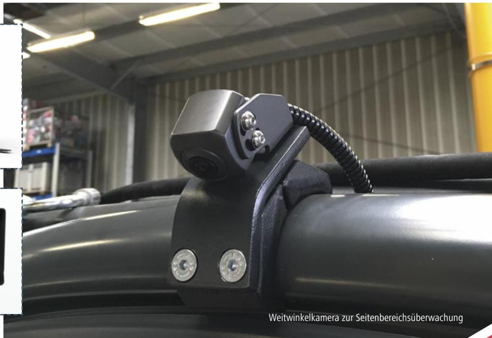
Weitwinkelkamera zur Seitenbereichsüberwachung
