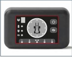
Die Fahrzeug-Unit warnt den Fahrer eines Flurförderzeuges durch LED-Leuchten und akustische Signale.
