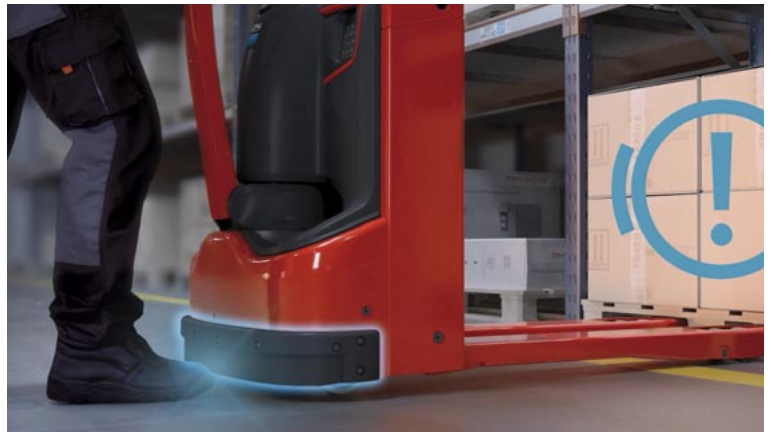
Bei Berührung der aktiven Fußschutzleiste stoppt das MFFZ umgehend und verhindert Fuß- oder Knöchelverletzungen. Mit der STOP&GO-Funktion springt der Mitgänger zusätzlich ein Stück zurück, um sich von dem Fuß des Bedieners zu entfernen.
