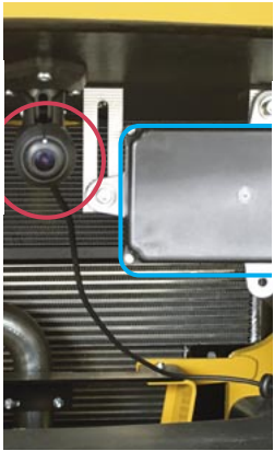
Radarsensor (auf dem Foto oben blau markiert) und Rückfahrkamera (rot markiert) ergänzen sich sinnvoll.
