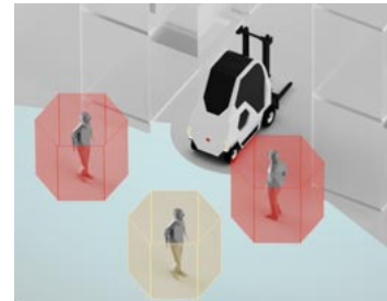
Grafik oben: Darstellung einer Personendetektion im rückwärtigen Gefahrenbereich eines Gabelstaplers durch die am Heck angebrachte KI-Kamera.
