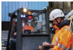
Das am Gabelstapler montierte System detektiert Personen, warnt den Fahrer und vermeidet Fehlalarme.
