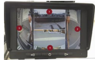
Die Aufnahmen der einzelnen Kameras zeigen zusammen auf dem Monitor angeordnet die Rundumsicht.
