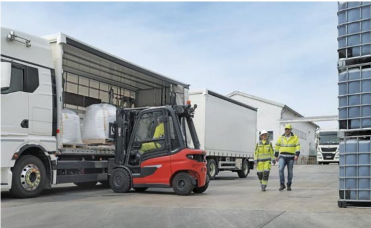
Die KI-Kamera detektiert die Personen hinter dem Stapler. Das System gibt sofort eine Warnung aus und reduziert die Fahrgeschwindigkeit.
