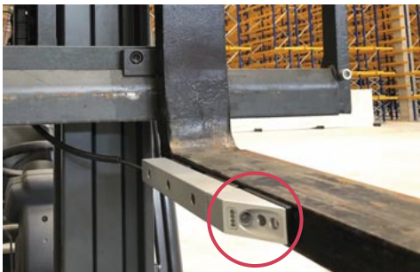
Mittels Gabelzinkenkamera hat der Fahrer/Bediener Sicht auf jeweiliger Höhe der Ladung.
