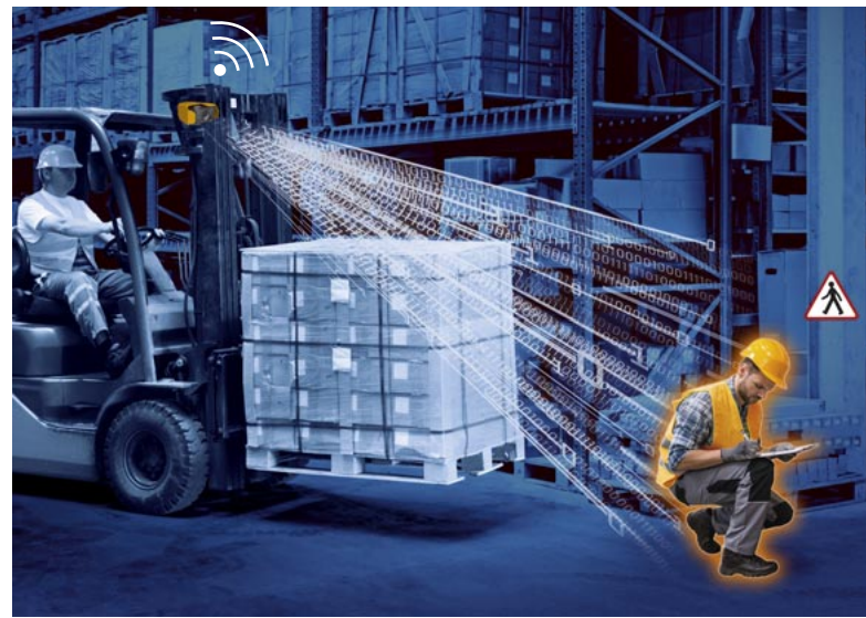
Abbildung oben: Der Sensor überwacht den Bereich in seinem Sichtfeld – auch im toten Winkel des Gabelstaplers – und erkennt jede Körperhaltung.
