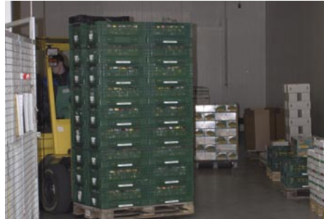
Anwendungsbeispiel: Unterstützung des Fahrers beim innerbetrieblichen Transport mit Sichteinschränkung durch Ladung.
