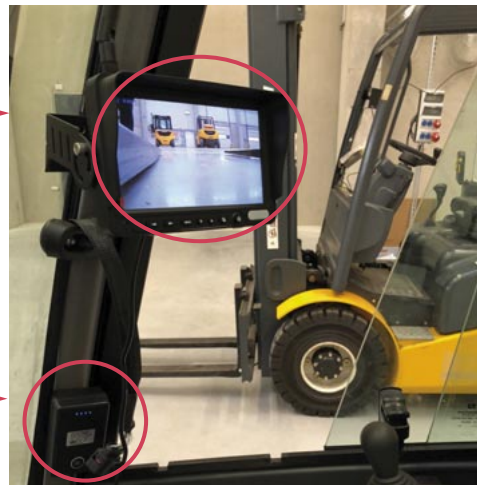
Beispiel für ein KMS mit kabelloser Bildübertragung, mit Digitalmonitor und Akku in der Fahrerkabine eines Staplers.
