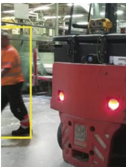
Der Fußgänger wird vom System detektiert, als Person klassifiziert und durch gelbe Rahmenlinien deutlich markiert.
