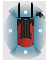
Die Aufnahmen der einzelnen Kameras zeigen zusammen auf dem Monitor angeordnet die Rundumsicht.
