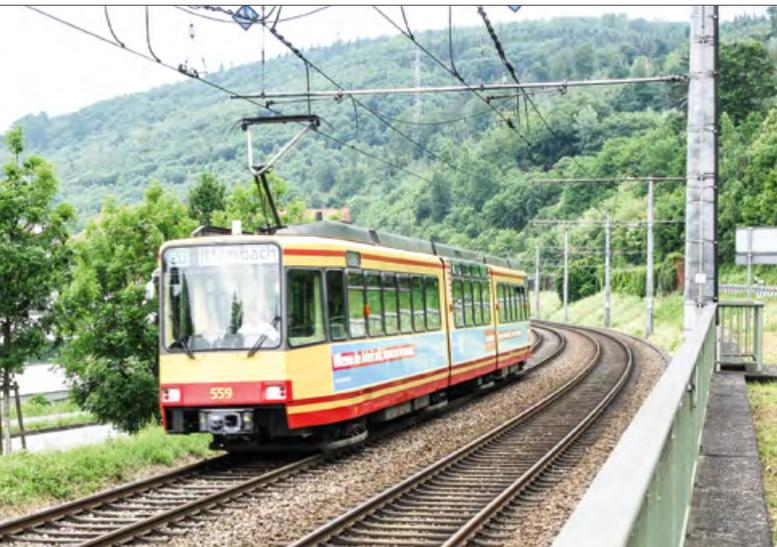
Abbildung 23: Fahrleitungsspannung und Schutzabstand müssen allen Beteiligten bekannt sein. Hier wird eine Nichtbundeseigene Eisenbahn mit 750 V Gleichspannung betrieben. Fachleute können das an den eingebauten Isolatoren erkennen. Für bahntechnisch unterwiesene Personen beträgt daher der Schutzabstand 1,0 m.
