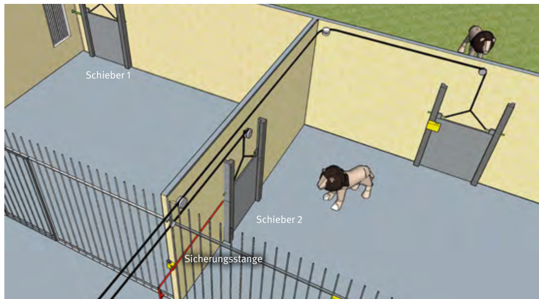
Abbildung 27: Schieber 1 (links) ist geschlossen und gesichert, Schieber 2 (Mitte) ist geschlossen, aber nur einfach gesichert (die Sicherungsstange ist nicht eingerastet).
