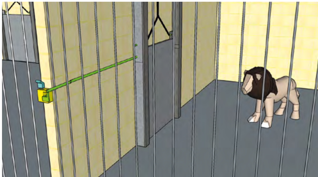
Abbildung 28: Der Schieber ist geschlossen, gesichert sowie verriegelt mit Zuhaltung (die Sicherungsstange ist eingerastet).
