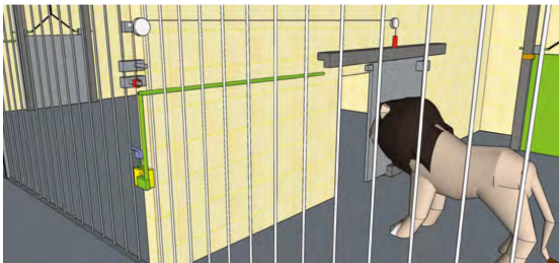
Abbildung 20: Detailaufnahme der abgerissenen Schubstange
