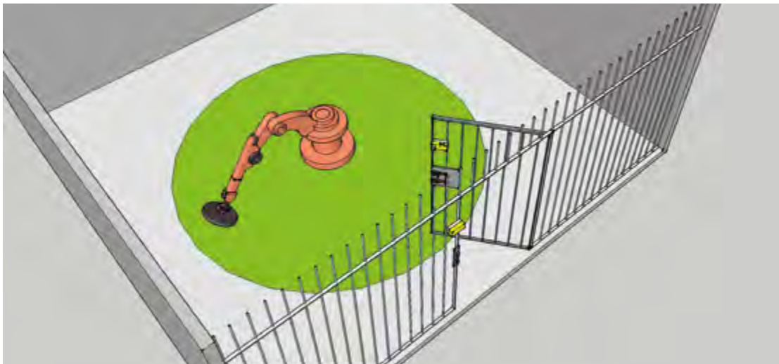
Abbildung 3: Die Maschine wurde abgeschaltet (Maschinenarm ist abgesenkt) und der Gefahrenbereich ist jetzt sicher (grün). Jetzt gibt die Zuhaltung (gelb) frei und die Tür kann geöffnet werden, da die Maschine zum Stillstand gekommen ist.
