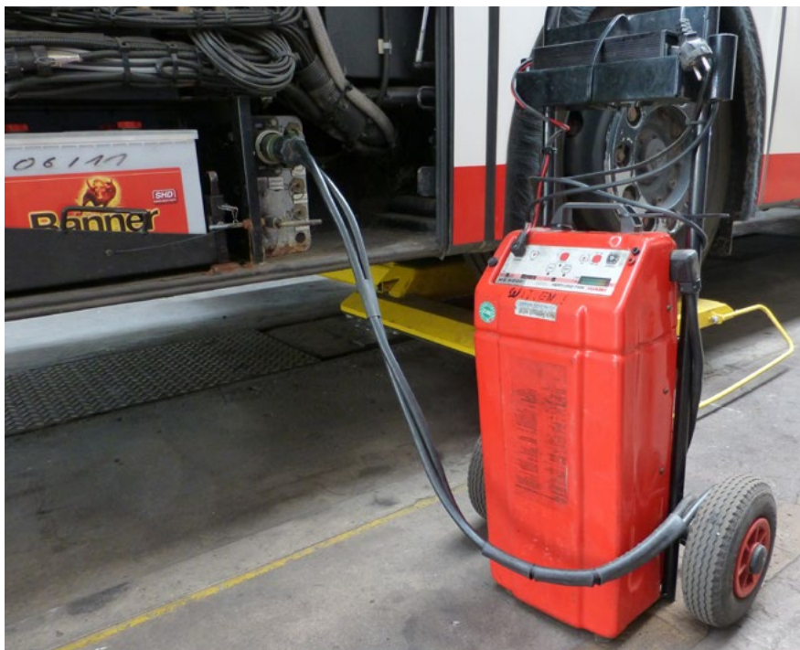
Starthilfegeräte sind im Bedarfsfall schnell am Einsatzort. Mit ihnen kann eine elektrische Verbindung zur Fahrzeugbatterie funkenfrei hergestellt werden.
