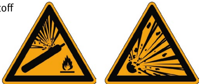
Abbildung 11: Warnschilder unter Druck stehende Gase und Explosionsgefährdung
