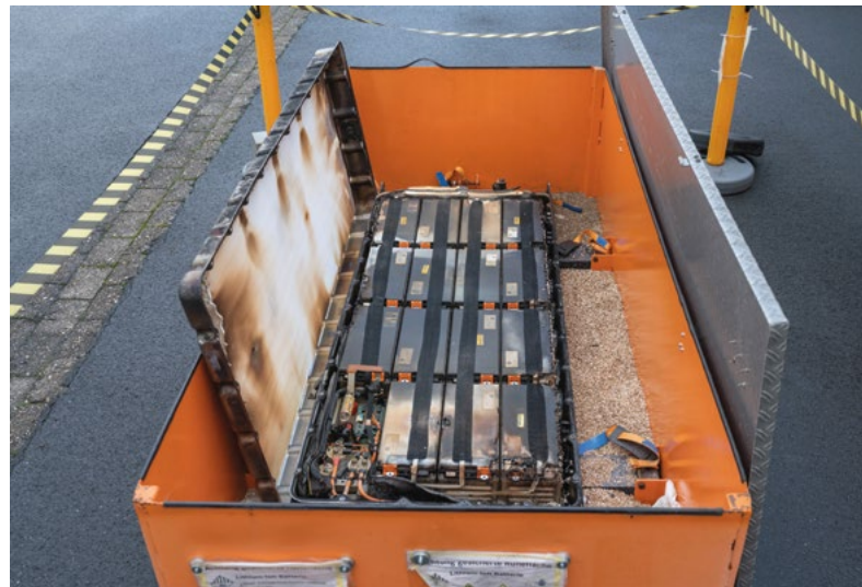
Abbildung 18: Beschädigte HV-Batterie nach Brand
