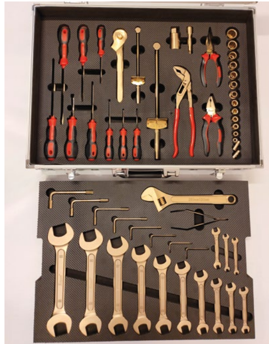
Abbildung 12: ATEX funkenfreies Werkzeug
