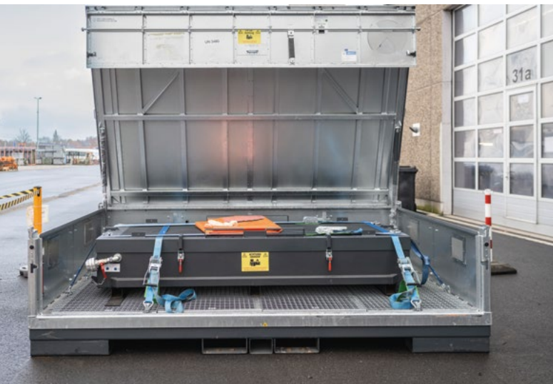
Abbildung 17: Gefahrstofflager für beschädigte (n. i. O.) HV-Batterien
