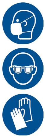
Big-Bags nur bei laufender Entstaubung leeren. Vorratsbehälter und Mischer nur bei laufender Absaugung befüllen. Staubentwicklung vermeiden. Schüttböden gering halten.
