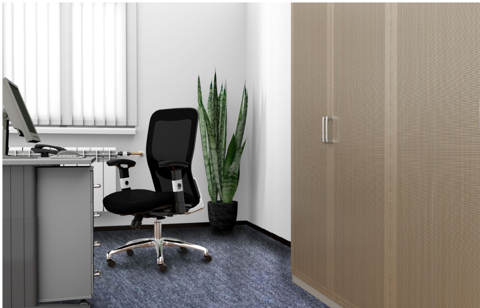
Abb. 10 Möglichkeiten zur Verbesserung der Raumakustik: Schallabsorbierende Lamellenstores und Möbel mit Schallabsorptionsfläche sowie schallabsorbierender Teppichboden
