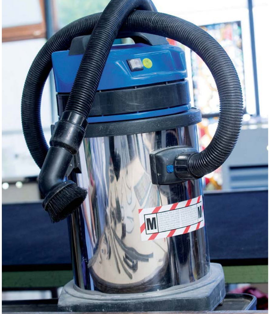
Abbildung 2: Staubsauger fur bleihaltige Stube (mindestens Kategorie „M“)
