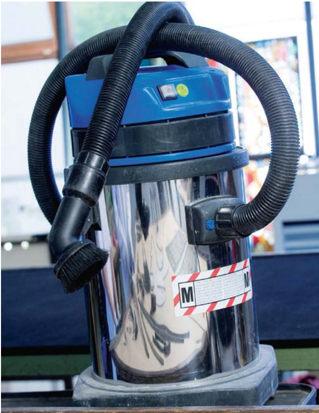
Abbildung 2: Staubsauger für bleihaltige Stäube (mindestens Kategorie „M“)
