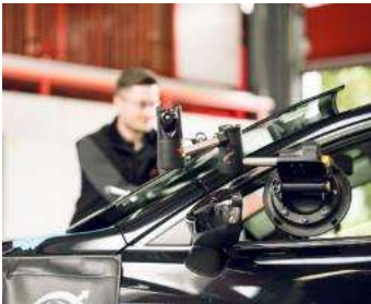
1-Tek® - Scheibenlifter: Weiterentwicklung bestehender Systeme, womit ein unkompliziertes, kraftschonendes & ergonomisches Anheben und Einsetzen der Scheibe möglich ist.
