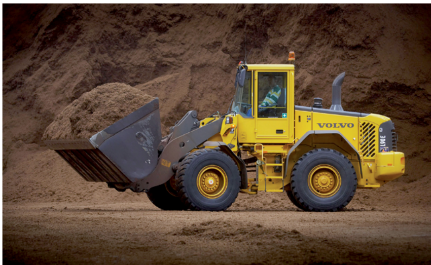
Abbildung 7: Geeignete Fahrersitze können Ganzkörpervibrationen beim Fahren von Radladern vorbeugen.
