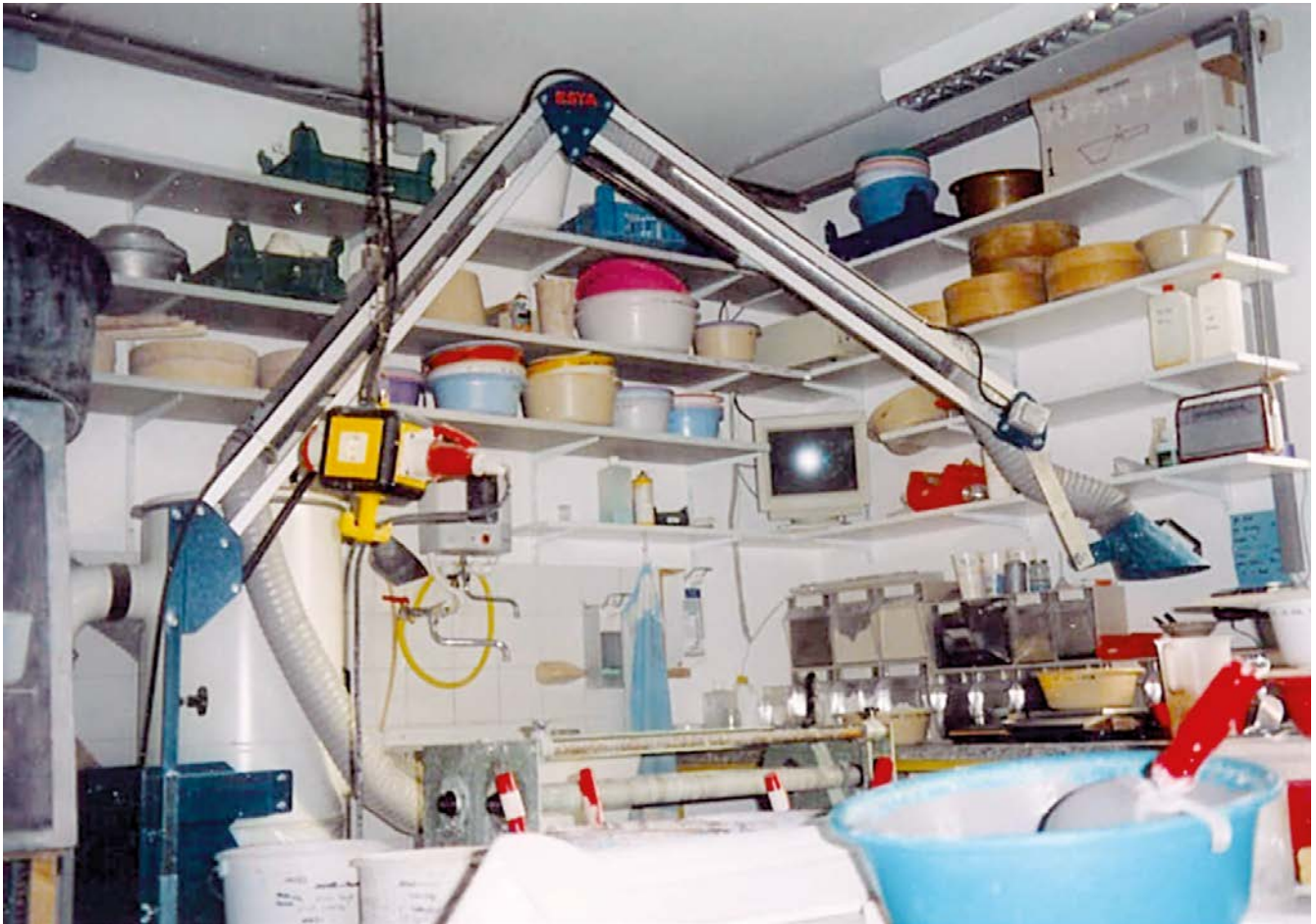
Abbildung 4: Glasuraufbereitung mit schwenkbarem Absaugarm
