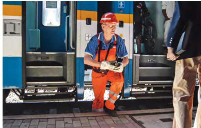
Abbildung 15: Beim Kuppeln von Reisezugwagen ist ein Schutzhelm zu tragen, da nicht richtig gesicherte Übergangsbleche den Beschäftigten gefährden können.
