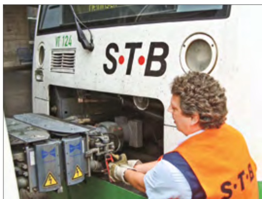
Abbildung 16: Bei der Notlösung dieser automatischen Kupplung muss keine Anstoßkappe getragen werden. Erforderlich sind aber in diesem Fall Warnweste, Handschuhe und trittsichere Schuhe.
