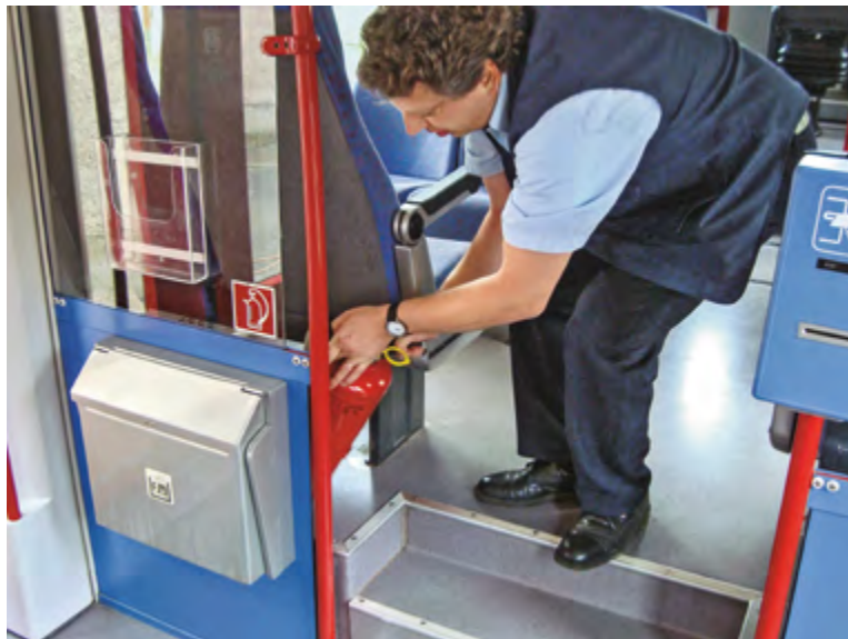
Abbildung 21: Bei der jährlichen Arbeitsschutz- unterweisung werden Beschäf- tigte auf die Standorte und die richtige Handhabung der in den Fahrzeugen vorhandenen Feuer- löscher hingewiesen.
