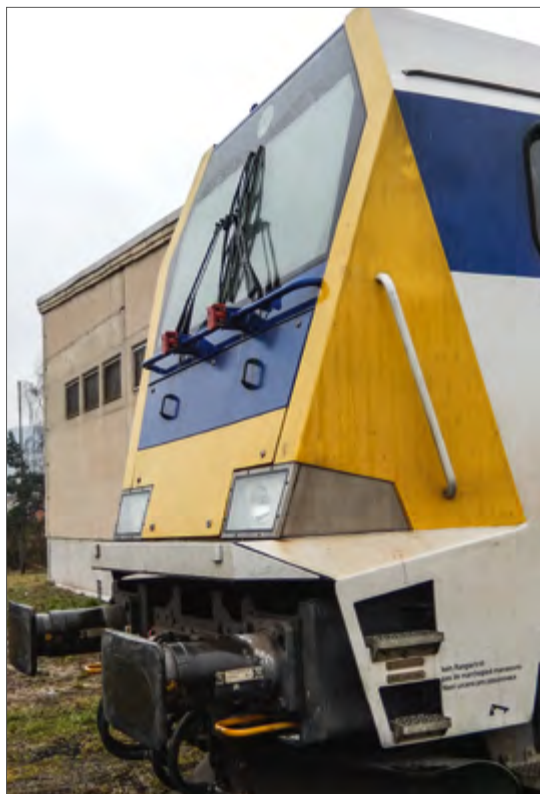
Abbildung 14: Beispiel für eine Kennzeichnung von Tritten an Lokomotiven, auf denen auch während Rangierfahrten nicht mitgefahren werden darf.
