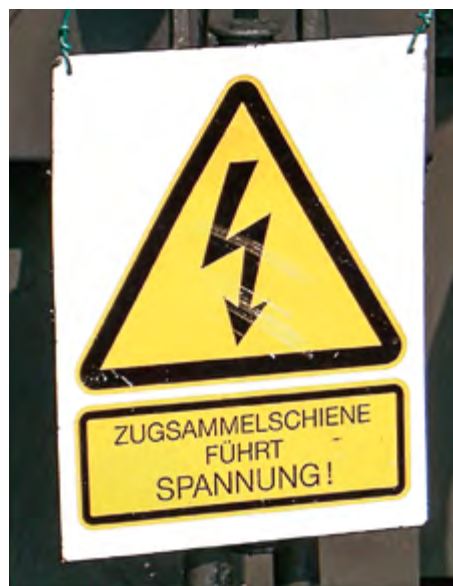
Abbildung 18: An Wagengruppen, die an Zugvorheizanlagen angeschlossen sind, müssen Warnschilder angebracht werden.
