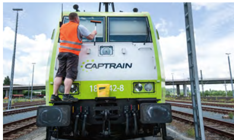
Abbildung 7: Zur Stirnfensterreinigung an Endführerstandslokomotiven sind die dafür vorgesehenen Trittflächen zu nutzen. Arbeitsgrenze ist die Oberkante der Stirnscheibe.
