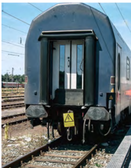
Abbildung 18: An Wagengruppen, die an Zugvorheizanlagen angeschlossen sind, müssen Warnschilder angebracht werden.
