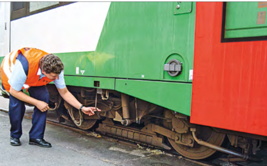
Abbildung 6: Für den Kontrollgang um das Fahrzeug muss ein ebener, trittsicherer und nachts auch beleuchteter Abstellplatz vorhanden sein.
