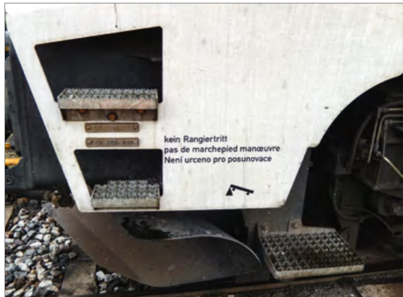
Abbildung 14: Beispiel für eine Kennzeichnung von Tritten an Lokomotiven, auf denen auch während Rangierfahrten nicht mitgefahren werden darf.
