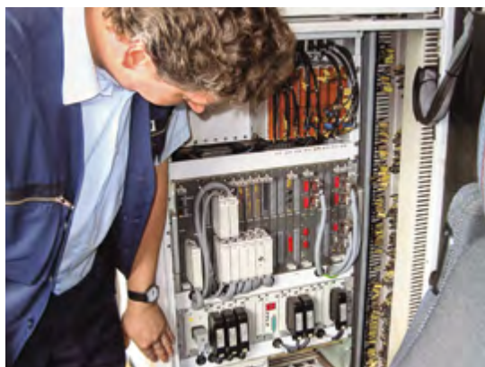
Abbildung 20: Bei Fahrzeugstörungen ist zunächst nach den vorgegebenen Störsuchplänen zu arbeiten.
