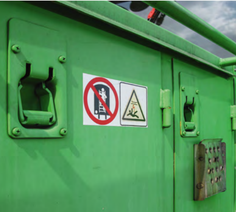
Abbildung 23: Die Kennzeichnung am Vorbau einer Mittelführerstand-lokomotive weist auf das Verbot des Aufsteigens über den ausklappbaren Tritt unter einer eingeschalteten Oberleitung hin!
