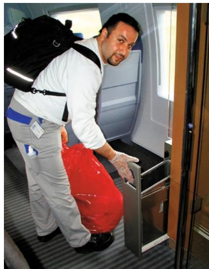
Für die schnelle Reinigung zwischendurch müssen sich Abfallbehälter ohne Hineingreifen entleeren lassen.
