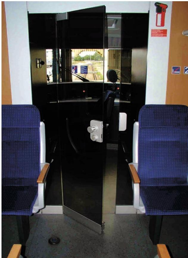
Die Tür zur Fahrerkabine ist gleichzeitig Fluchtweg bei Gefahr. Sie muss von innen deshalb jederzeit ohne Schlüssel zu öffnen sein. Für den Fall, dass die Tür durch abgestelltes Reisegepäck blockiert ist, muss sie auch nach innen geöffnet werden können.
