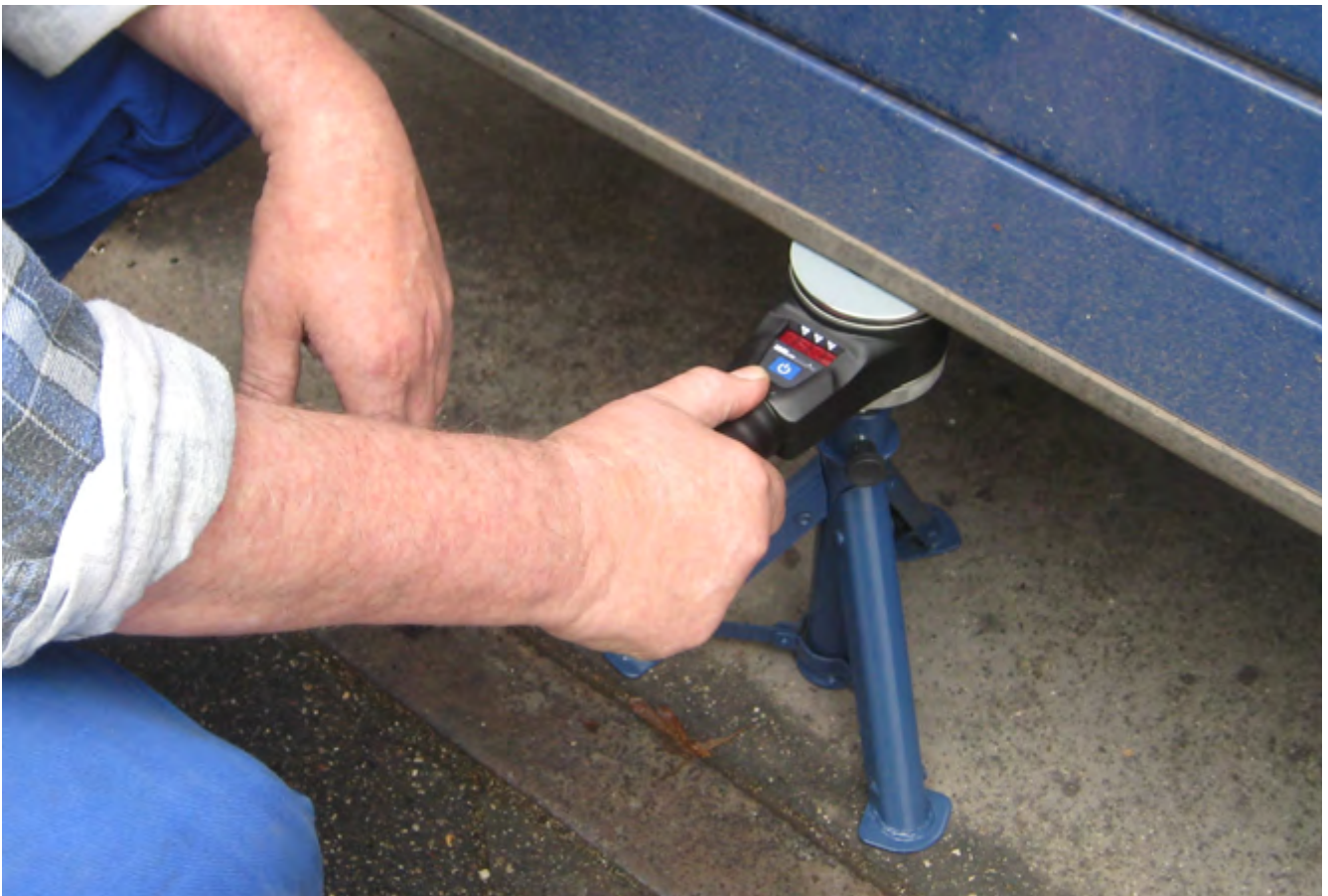
Abb. 25 Schließkraftmessung an der Hauptschließkante eines Torflügels
