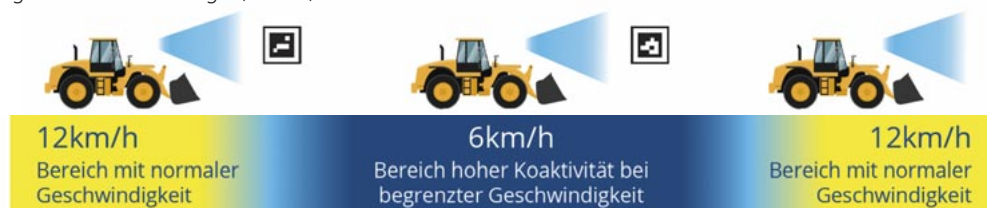
Abbildung rechts: Beispiel einer automatischen Geschwindigkeitsbegrenzung bei einem Radlader
