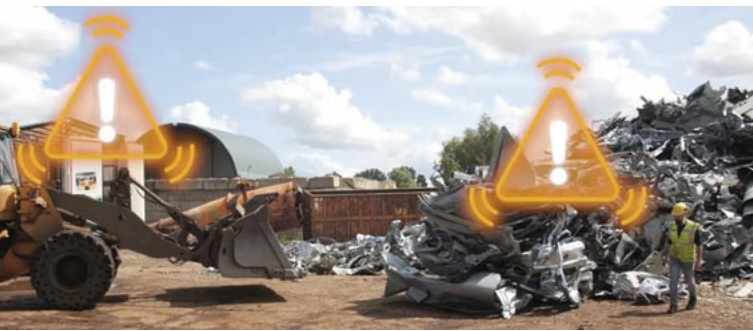
Foto oben: Ein Tag-basiertes System ermöglicht das Detektieren einer Person sogar hinter einem Schrotthaufen – hier mittels RFID-Technologie.
