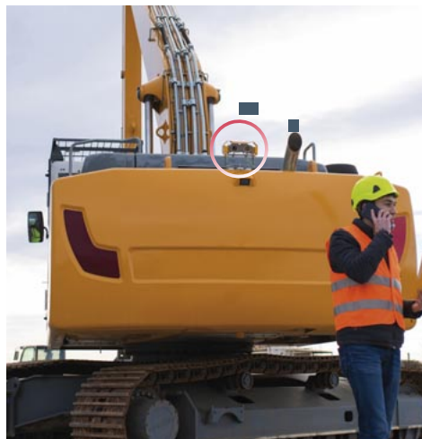
3D-Kamerasensoren/Stereokameras werden auf Baustellen an großen Maschinen, wie beispielsweise Kettenbagger (Foto oben) eingesetzt.
