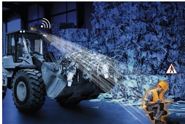
Abbildung oben: Der Sensor überwacht den Bereich in seinem Sichtfeld – auch im toten Winkel des Radladers – und erkennt jede Körperhaltung.
