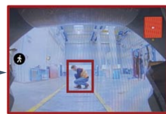
Abbildung oben: Der Sensor überwacht den Bereich in seinem Sichtfeld – auch im toten Winkel des Radladers – und erkennt jede Körperhaltung.
