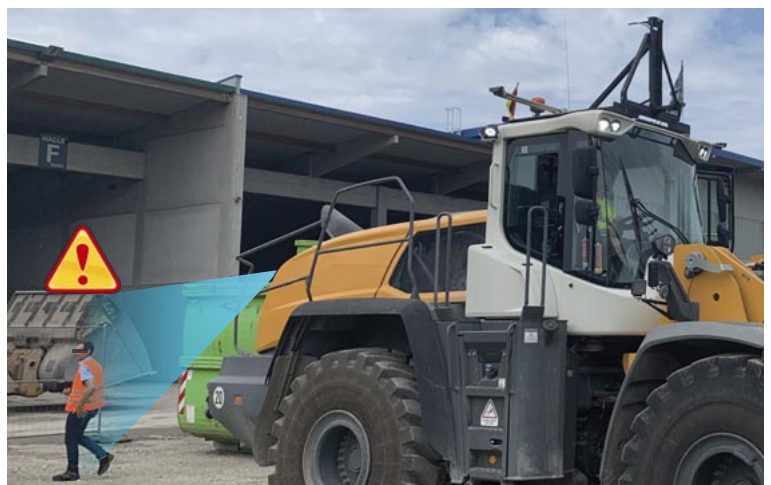
Bild oben: Darstellung der Personendetektion im hinteren Bereich des Radladers, die sowohl die Warnung an den Fahrer als auch den automatischen Bremsvorgang der Maschine auslöst.
