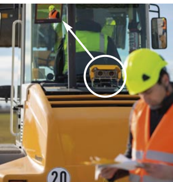
Bild unten: 3D-Kamerasensor im Off-Road-Bereich. Der Fahrer/ Bediener wird vor der drohenden Kollision gewarnt und sieht im Monitor der Fahrerkabine die gefährdete Person, die sich hinter der Maschine befindet.
