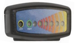
Abbildung oben: Das Display in der Fahrerkabine signalisiert, ob und wie nah sich ein Objekt in der Gefahrenzone der Arbeitsmaschine befindet – und ob es sich nähert oder entfernt.
