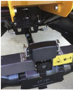
Oberes Bild: Radarsensor an einer Baumaschine
