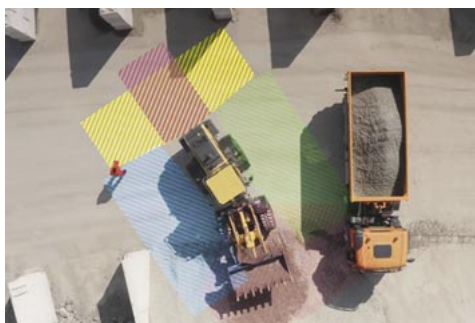
Bild 1: Darstellung der Sichtfelder eines Surroundview-KMS
