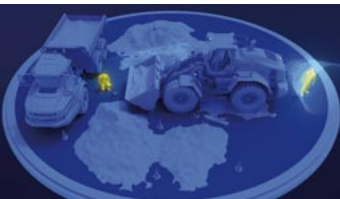
Abbildung oben: Die beiden am Radlader (vorne und hinten) montierten Systeme detektieren und lokalisieren in Echtzeit Personen und warnen den Fahrer im Gefahrenfall – ohne unnötig zu alarmieren.
