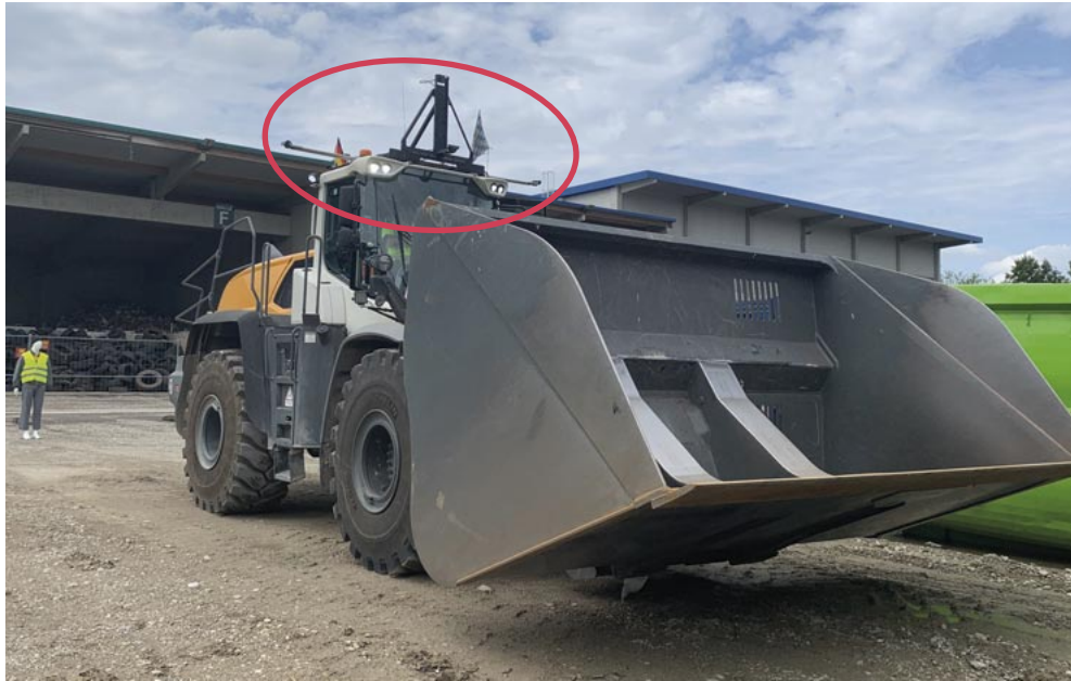
Bild oben: Rundumsicht-KMS bieten dem Bediener Übersicht für die nähere Umgebung. Ein rundum kontrollierbares Sichtfeld ermöglicht schnelles, präzises und stressfreies Arbeiten, auch z. B. bei Spezialanwendungen mit Volumenschaufel (siehe dazu auch DGUV-Publikation „FBHM-109: Radlader mit Leichtgutschaufel“).
