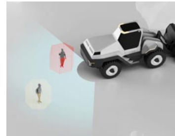
Grafik oben: Darstellung einer Personendetektion im rückwärtigen Gefahrenbereich eines Radladers durch die am Heck angebrachte KI-Kamera.
