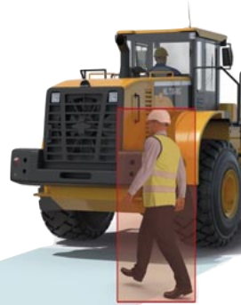
Abbildung oben: Radlader mit KI-Kamera-Monitor-System zur Personendetektion im rückwärtigen Gefahrenbereich.
