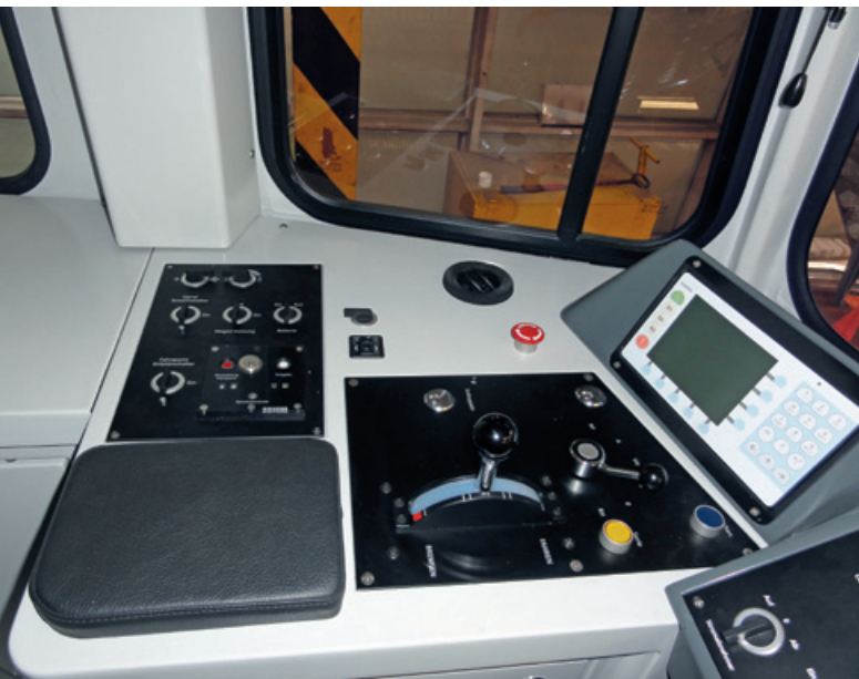
Der Sollwertgeber als Fixpunkt am Fahrerarbeitsplatz ist ergonomisch mit Armabstützung angeordnet.
