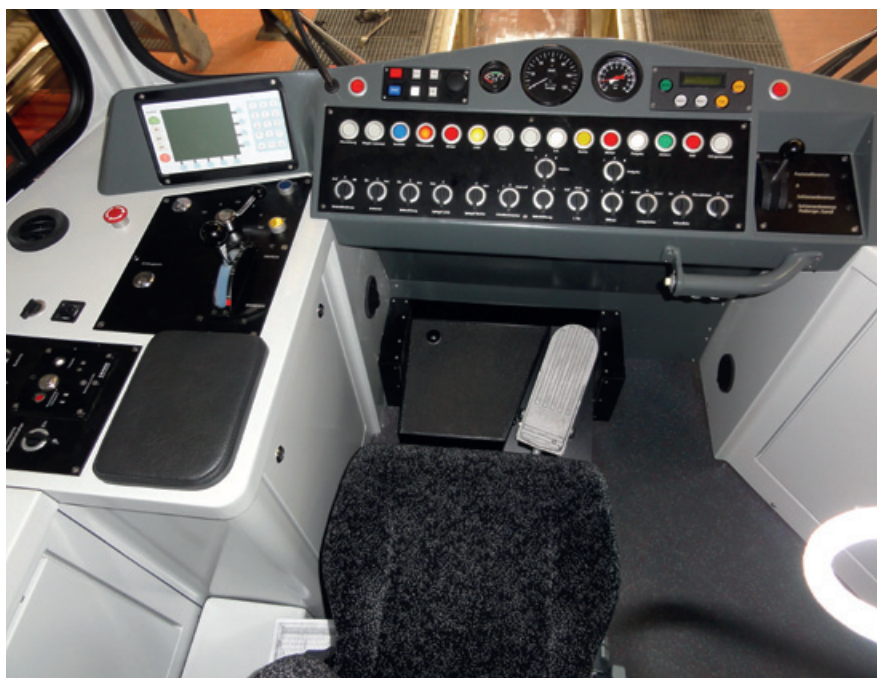
Mit der Fahrzeug-Modernisierung lassen sich die ergonomischen Bedingungen an Fahrerarbeitsplätzen deutlich verbessern.
