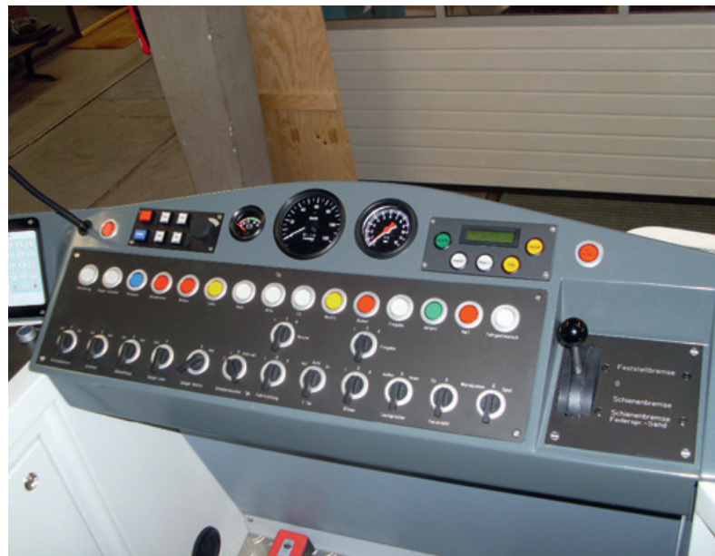
Die Bedienelemente sind als Tast- und Drehschalter ausgebildet und entsprechen mit geeigneter und farblicher Kennzeichnung modernen Standards.
