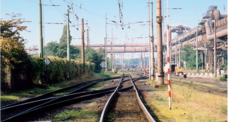
Oberleitungen, Speiseleitungen und Stromschienen für elektrisch betriebene Eisenbahnen stehen unter Spannungen bis 15.000 Volt, teilweise sogar bis 25.000 Volt. Die Spannung liegt auch an den Stromabnehmern der Schienenfahrzeuge an. Bei S-Bahnen können sich die Stromabnehmer seitlich der Fahrwerke befinden.
