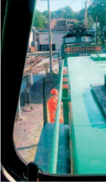
Abbildung 5: Die Lokführerin beziehungsweise der Lokführer kann vom Führerstand aus Personen nicht erkennen, die direkt vor dem Triebfahrzeug stehen.
