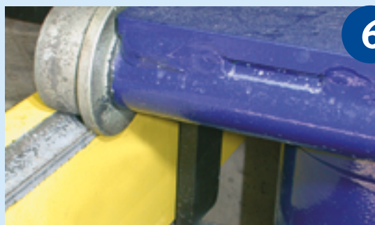
Kippsicherung des Fahrwagens
