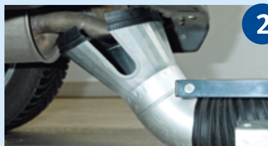
2 Vollständige Erfassung der Abgase durch richtige Positionierung
