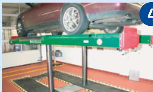
Zweistempel-Hebebühne mit integriertem Bodenausgleich
