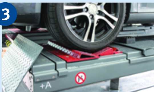
Integrierter Achsspieltester, Radfreiheber und Sicherung gegen Wegrollen
