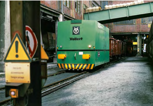
Abbildung 33: Das Rangierfahrzeug ist in einem abgegrenzten Rangierbereich eingesetzt.
