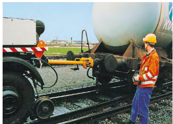
Abbildung 30: Mit der Kuppelstange kann automatisch gekuppelt werden. Sie ist am Straßenfahrzeug angebracht und wird vor dem Kuppeln auf die Höhe des Zughakens eingestellt.
