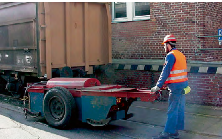
Abbildung 8: Auch beim Schieben von Wagen, zum Beispiel mit einem nichtspurgeführten Wagenschieber, ist der zu befahrende Gleisbereich zu beobachten. In der Regel ist dafür ein zweiter Beschäftigter erforderlich.
