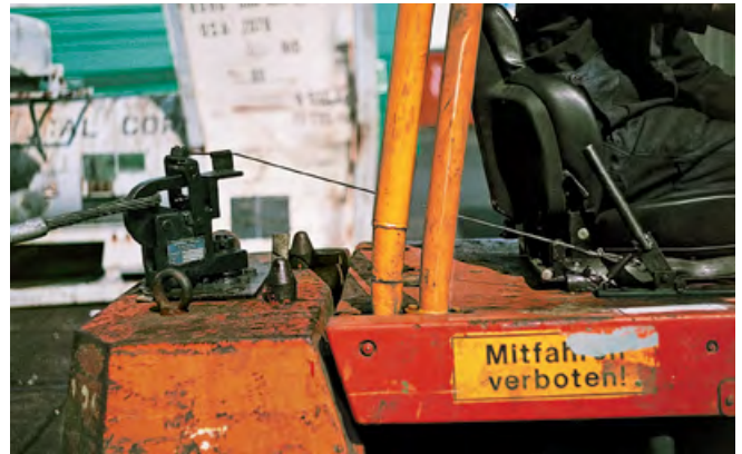
Abbildung 26: Mit der Slipkupplung wird das Seil bei mehr als 45° seitlichem Schrägzug automatisch ausgeklinkt. Der Staplerfahrer oder die Staplerfahrerin kann im Gefahrfall die Kupplung über einen Seilzug auch unter Last öffnen.
