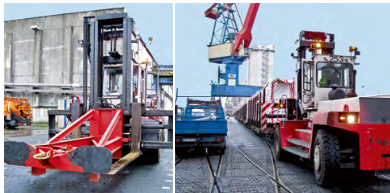
Abbildung 4: Hier wird die Rangierfahrt allein mit der Fahrzeugbremse des Gabelstaplers abgebremst. Vorausgegangen waren theoretische Überlegungen und Fahrversuche.
