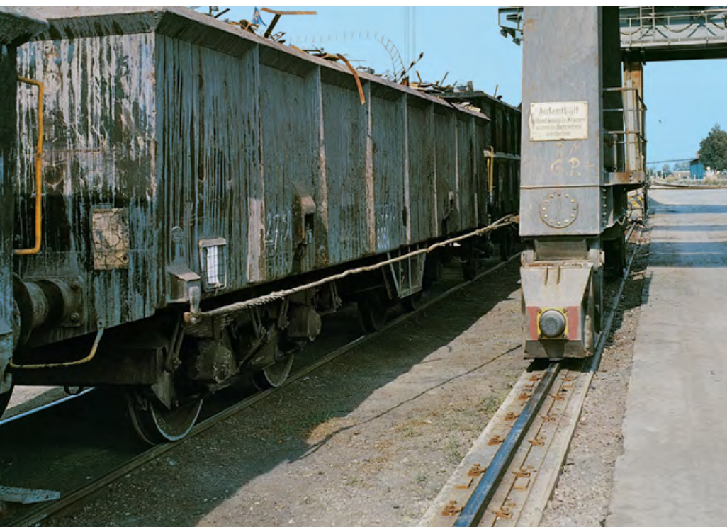
Abbildung 38: Wagen dürfen mit dem Kranfahrwerk des Portalkranes nur gezogen werden, wenn es für die einseitige Belastung ausgelegt ist. Die schriftliche Zustimmung der Kranherstellerfirma, alternativ eines oder einer Sachverständigen ist erforderlich.
