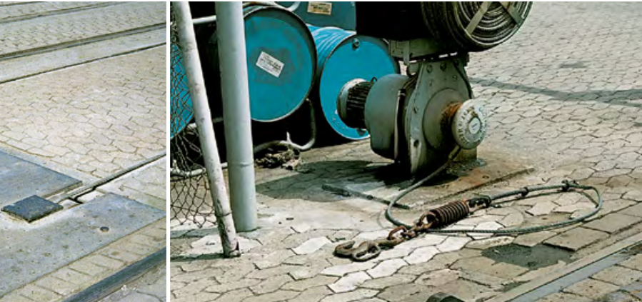
Abbildung 36: Das Zugseil der Spillwinde hat an seinem losen Ende einen Seilhaken mit Handgriff zum bequemen Einhängen in die Seilöse und ein elastisches Zwischenstück zum „weichen“ Anfahren des Wagens.
