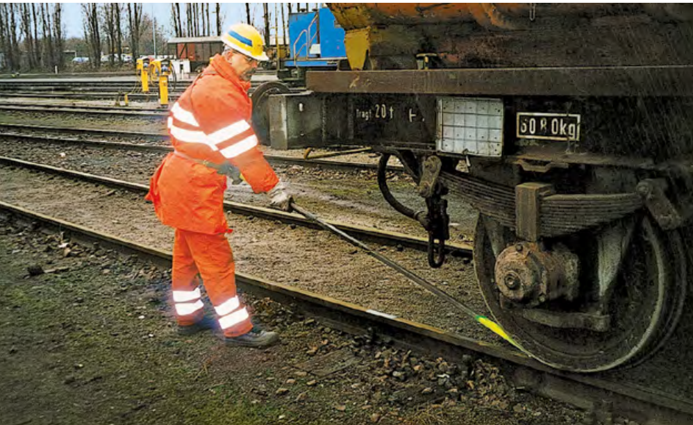
Abbildung 19: Die Knippstange ist an einem Rad der letzten Achse angesetzt. Der oder die Beschäftigte geht neben dem Fahrzeug.
