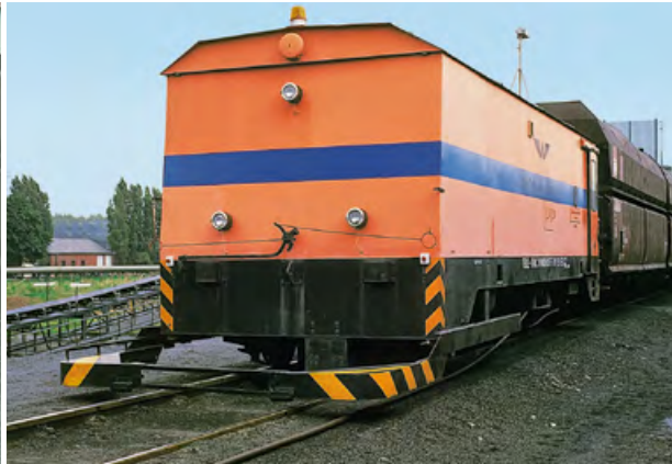
Abbildung 34: Berührt das Rangierfahrzeug ein Hindernis im Gleis, wird es über die Schalteinrichtung sofort festgebremst.
