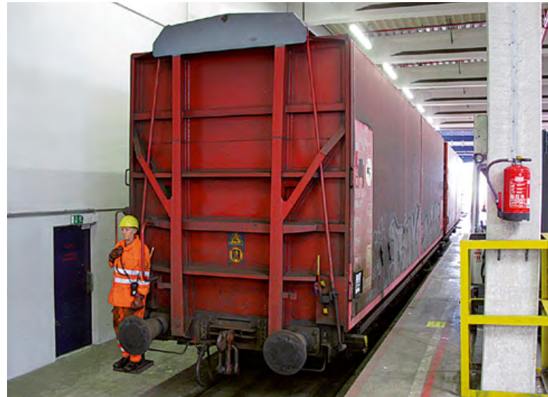
Abbildung 15: Rangierer dürfen sich niemals zwischen Gleis und Rampe aufhalten.
