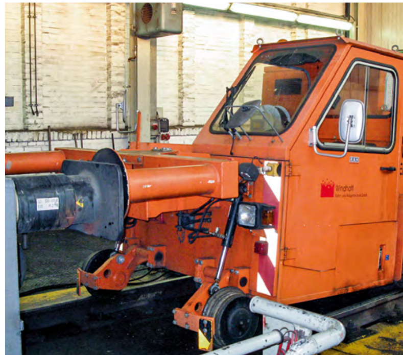
Abbildung 12: Bei diesem Rangiergerät ist eine pufferähnliche Stoßeinrichtung vorhanden, mit der der freizuhaltende „Berner Raum“ gewährleistet wird.
