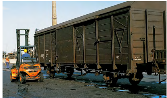
Abbildung 25: Beim Ziehen von Wagen fährt der Gabelstapler neben dem Fahrbereich. Das Zugseil ist am in Fahrtrichtung hinteren Seilhaken des Wagens eingehängt. Der Stapler muss mit einer Slipkupplung ausgerüstet sein.
