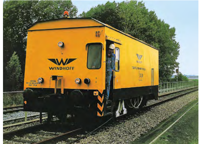
Abbildung 32: Das elektrisch angetriebene Rangierfahrzeug ist mit einem Hilfsführerstand ausgerüstet. Die Energie wird über Schleppkabel zugeführt.
