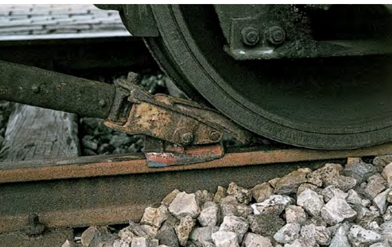
Abbildung 20: Der Wagenrücker hat seitliche Führungen zum Schutz gegen Abrutschen vom Schienenkopf.
