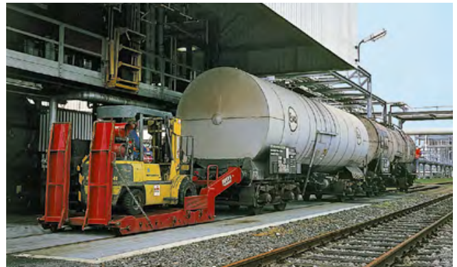
Abbildung 27: Die Rangiereinheit wird von einem serienmäßigen Gabelstapler mittels Rangiergerät geschoben. Beschäftigte, die zur Beobachtung des Gleisbereichs an der Spitze mitfahren, übermitteln der Staplerfahrerin oder dem Staplerfahrer über Funk die Rangiersignale.
