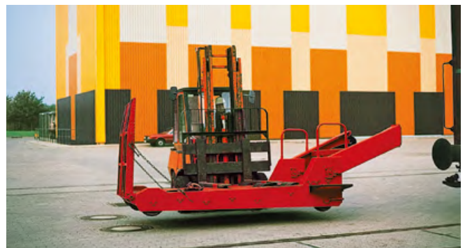
Abbildung 28: Das Rangiergerät wird mit einem Gabelstapler zum Einsatzort gefahren. Zum Eingleisen muss der Gleisbereich eingedeckt sein.
