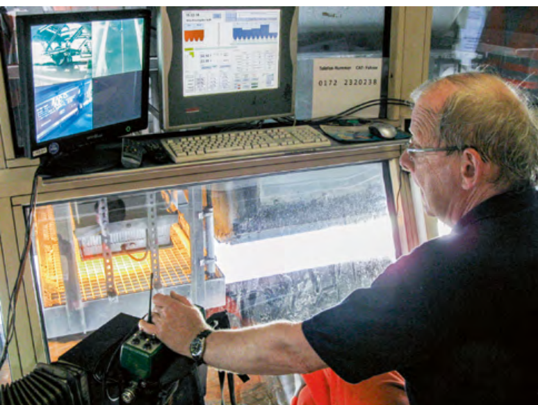
Abbildung 10: Der Ladestellenbediener darf die Wagen ferngesteuert verschieben, wenn er über ein Kamera-Monitor-System den zu befahrenden Gleisbereich einsehen kann.
