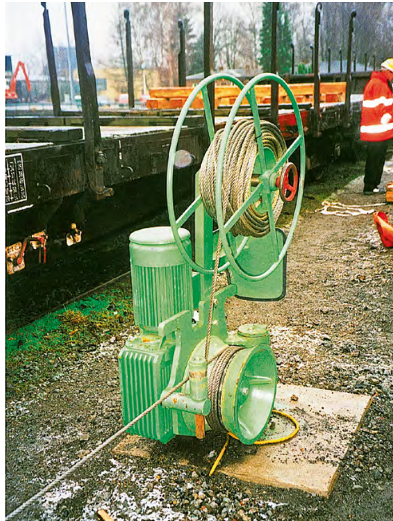
Abbildung 2: Für das Bewegen von Wagen mit Rangiermitteln, zum Beispiel mit einer Seilzuganlage, ist eine Betriebsanweisung aufzustellen.
