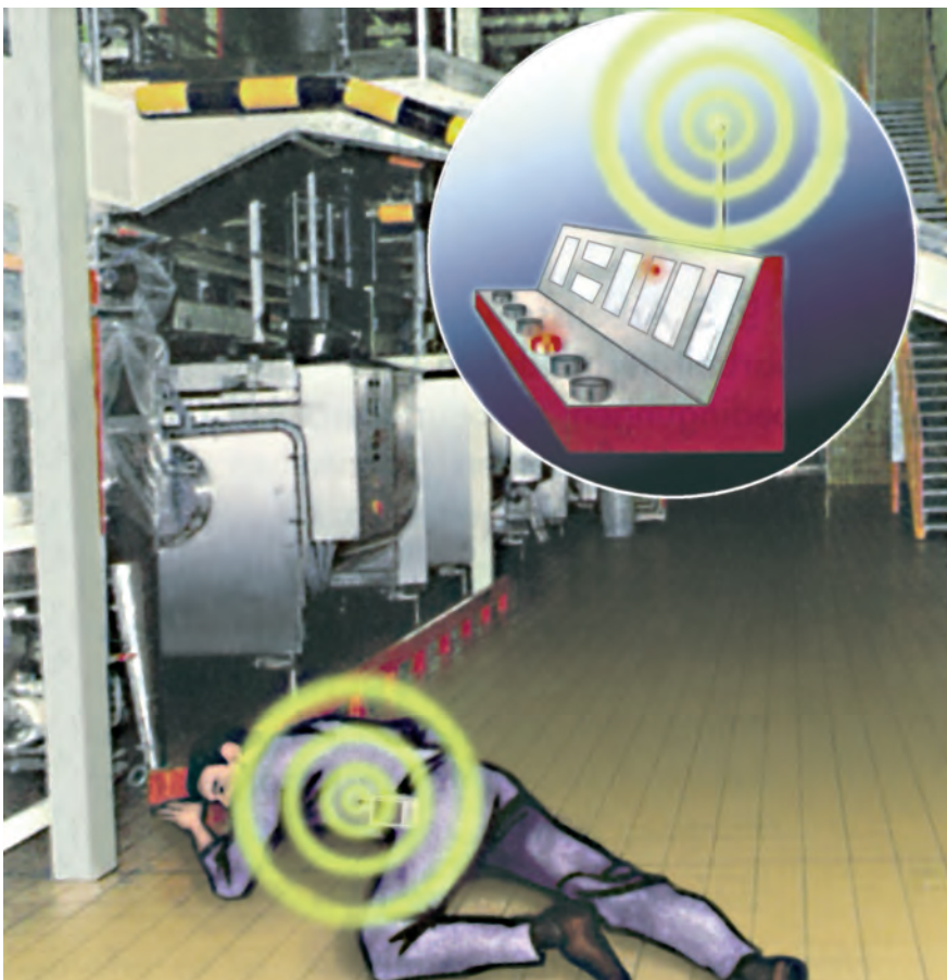
Abbildung 4: Schema einer Personen-Notsignal-Anlage
