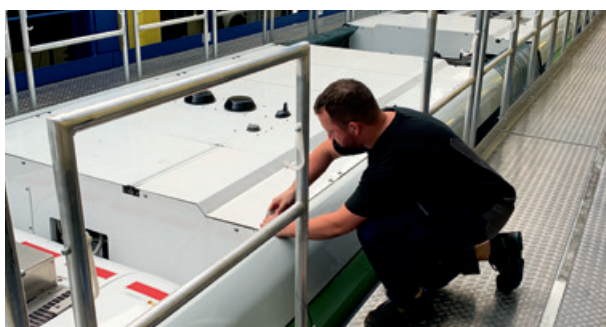
Seitlich und an der Stirnseite liegt die Arbeitsbühne ohne Spalt direkt am Fahrzeug an.
