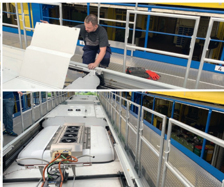
Seitlich und an der Stirnseite liegt die Arbeitsbühne ohne Spalt direkt am Fahrzeug an.
