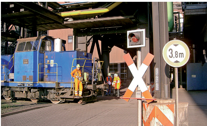
Abbildung 8: Durch die technische Sicherung dieses Bahnüberganges kann auf das Abgeben von Typhonsignalen zur Warnung anderer Verkehrsteilnehmenden verzichtet werden.
