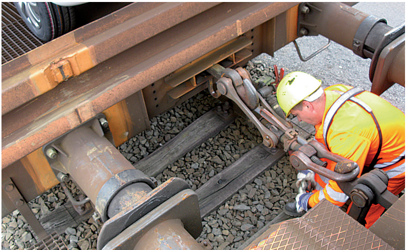
Abbildung 9: Beim Entkuppeln ist der Lrf erheblichen Lärmbelastungen durch ausströmende Druckluft ausgesetzt.
