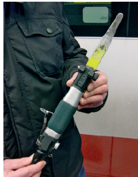
Die Arbeit mit oszillierenden Sägen schont das Hand-Arm-System. Sie können etwas länger als oszillierende Messer eingesetzt werden.
