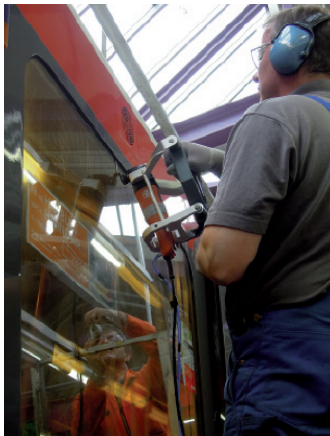
Beim Einsatz oszillierender Messer sind auf die Scheibenform abgestimmte Messeraufsätze zu verwenden.
