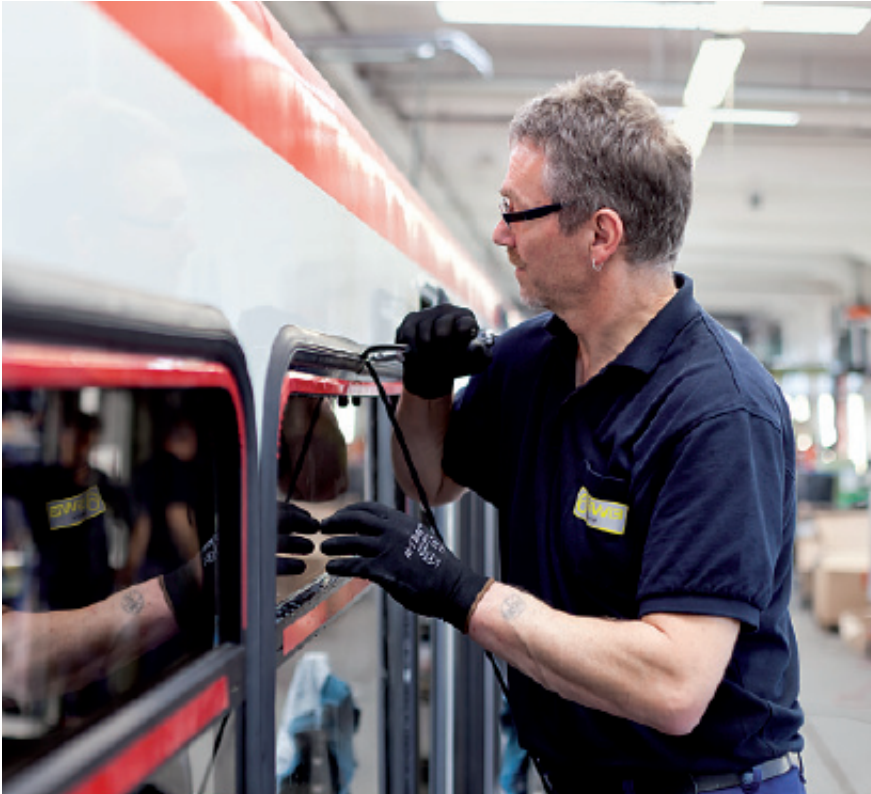
Der Ein- und Ausbau in Profilgummis eingesetzter Scheiben erfolgt vibrationsfrei.
