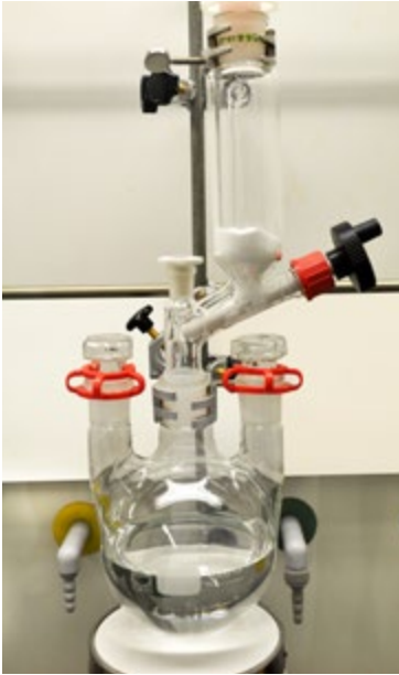
Abb. 8 Handbetätigter Pulverdosiertrichter auf einem Dreihalskolben
