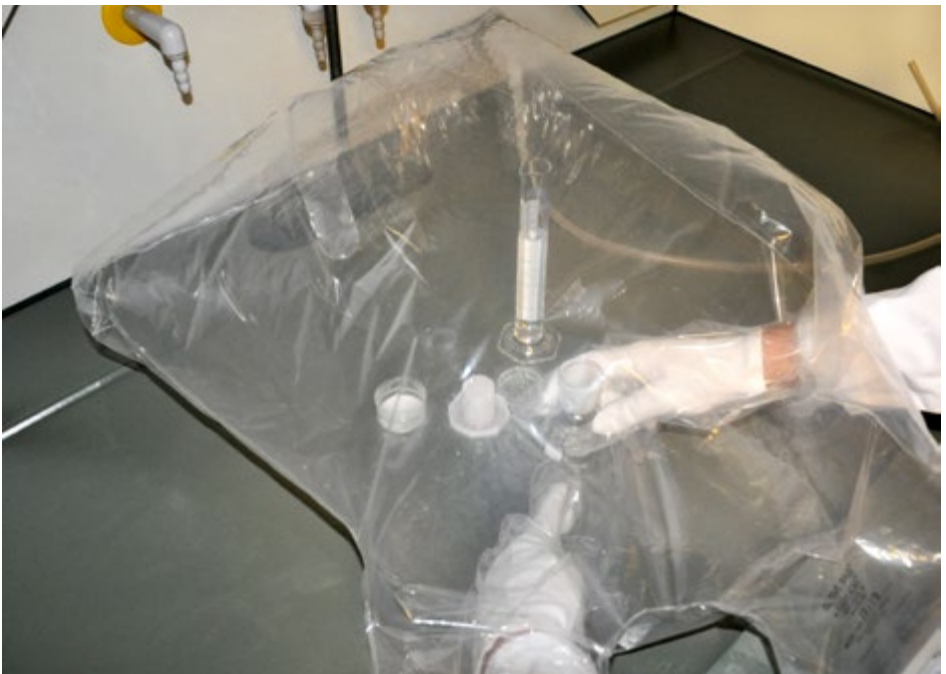
Abb. 14 Glovebag mit Verschlussclip der Beschickungsöffnung
