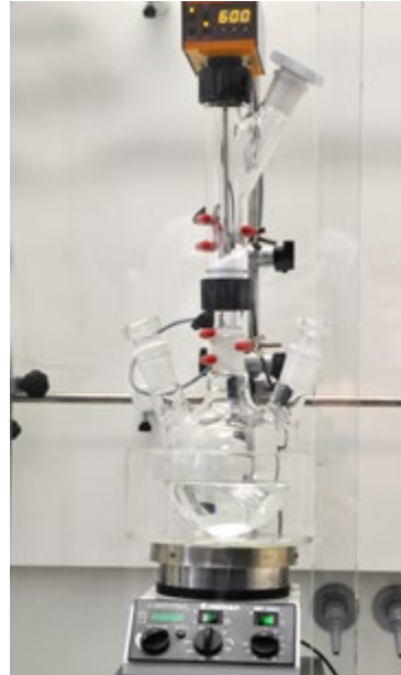
Abb. 9 Automatischer Pulverdosiertrichter für die gleichmäßige Zudosierung über längere Zeiträume
