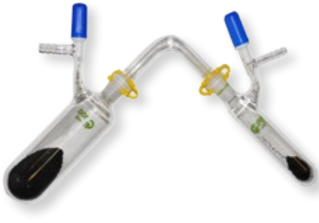
Abb. 6 Transferbogen für Pulver, geschützt vor Luftströmungen (wenn erforderlich, kann Inertgas – bevorzugt Ar – benutzt werden, um das Pulver gegen Feuchtigkeit und Luft zu schützen)
