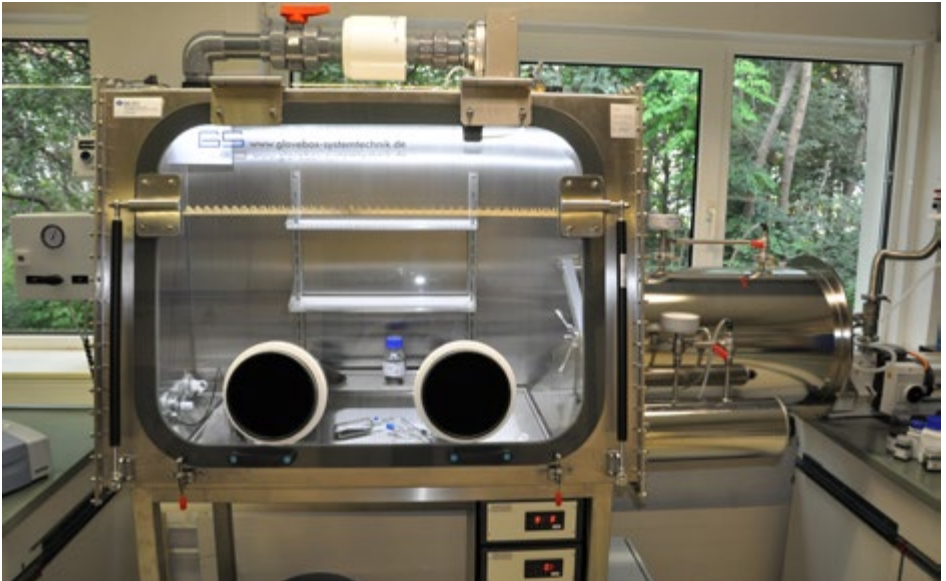
Abb. 13 Glovebox mit Schleusensystem
