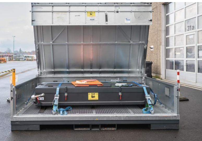
Abbildung 17: Gefahrstofflager für beschädigte (n. i. O.) HV-Batterien
