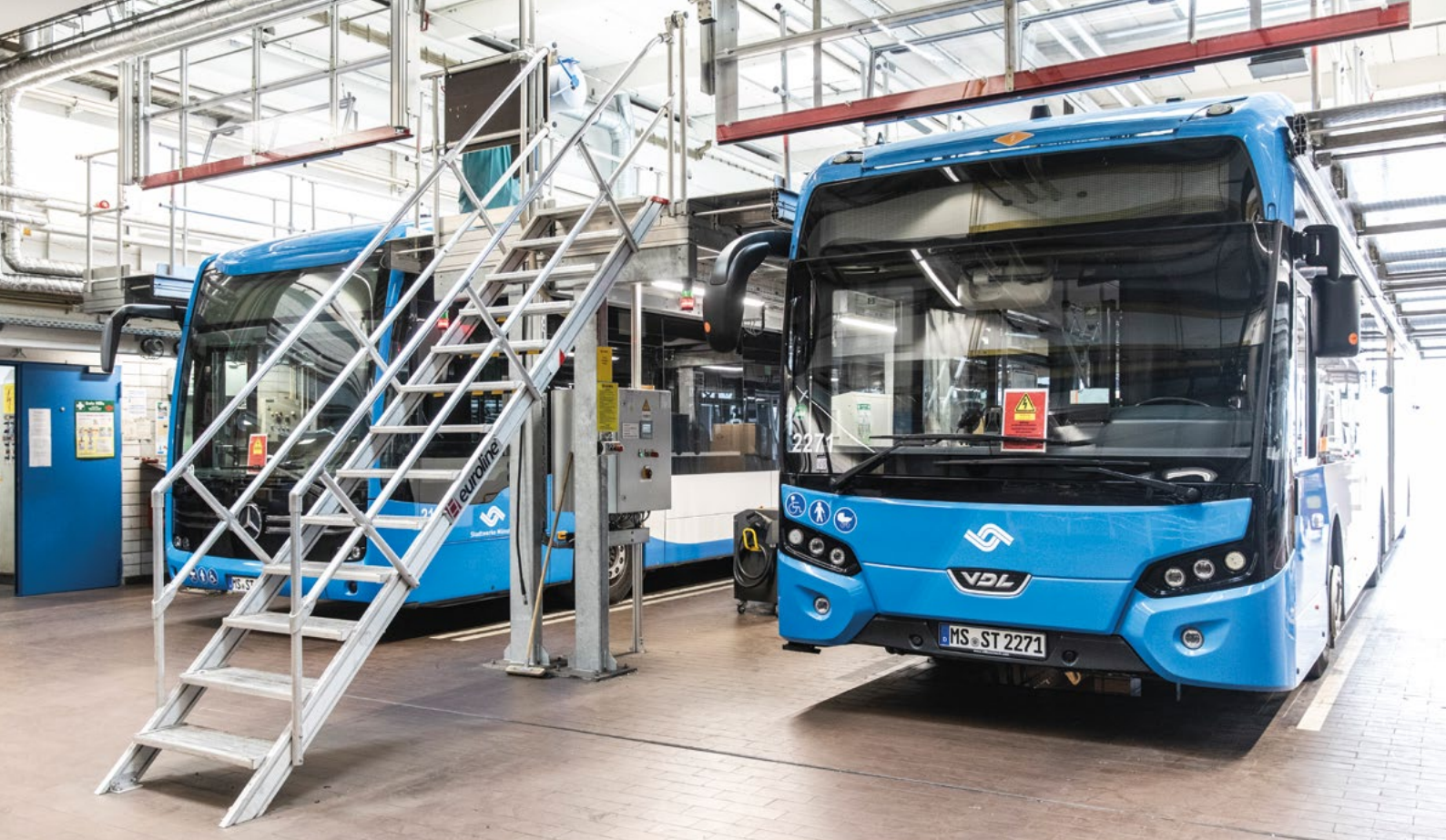
Abbildung 6: Busse im Dacharbeitsstand
