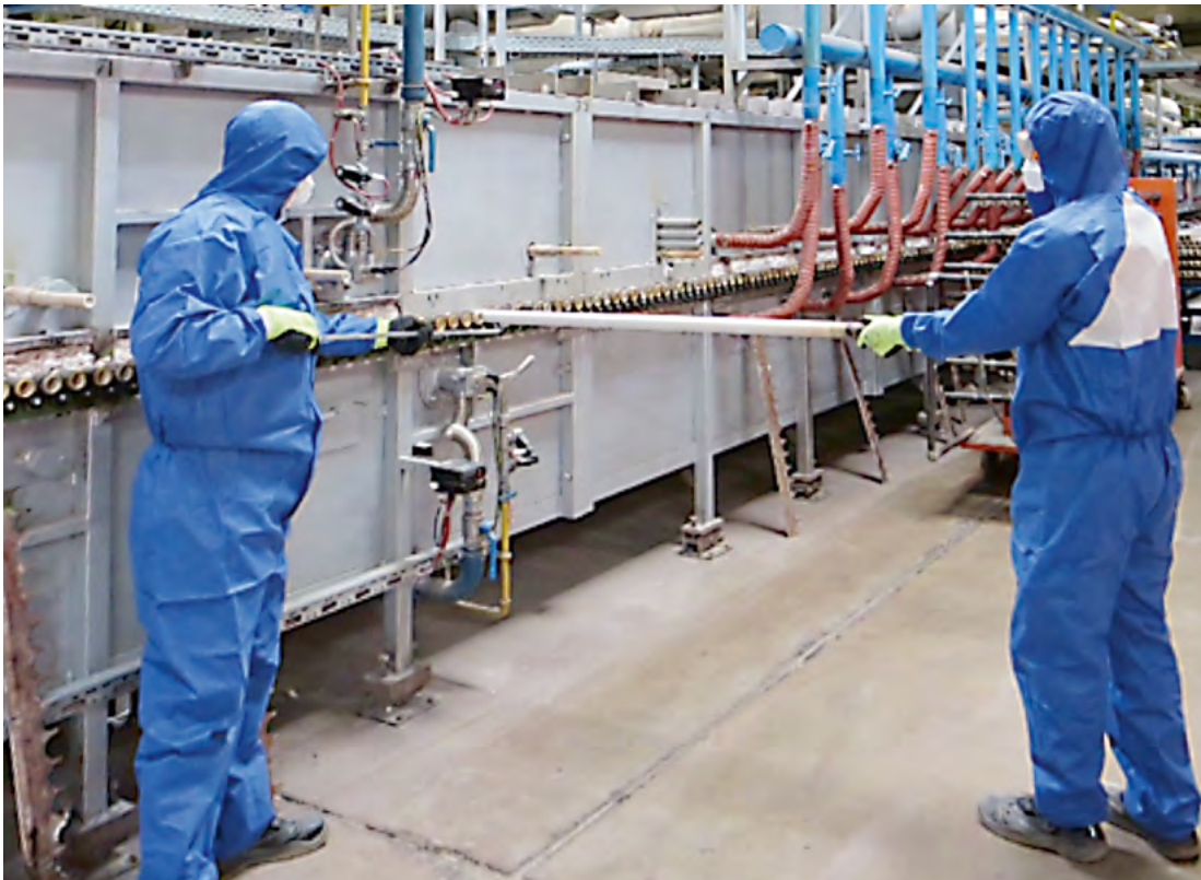
Abbildung 12: Austauschen von mit Aluminiumsi- likatfasern abge- dichteten Keramik- rollen an einem Durchlaufofen
