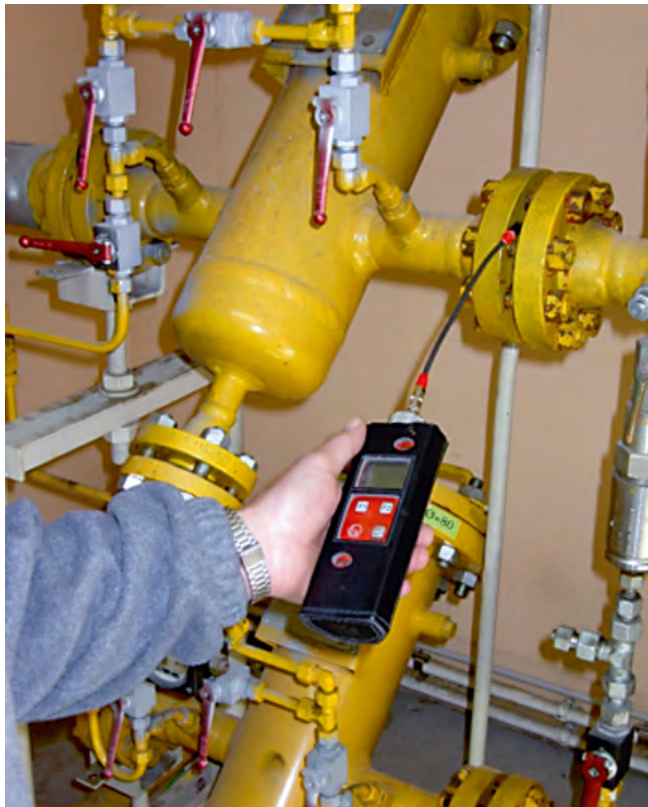
Abbildung 3: Prüfung der Dicht- heit mit einem Gasspürgerät
