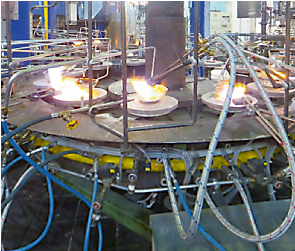
Abbildung 4: Feuerpolieranlage mit Bren- nern, die mit vorgemischter Brennstoff/Luft-Mischung arbeiten
