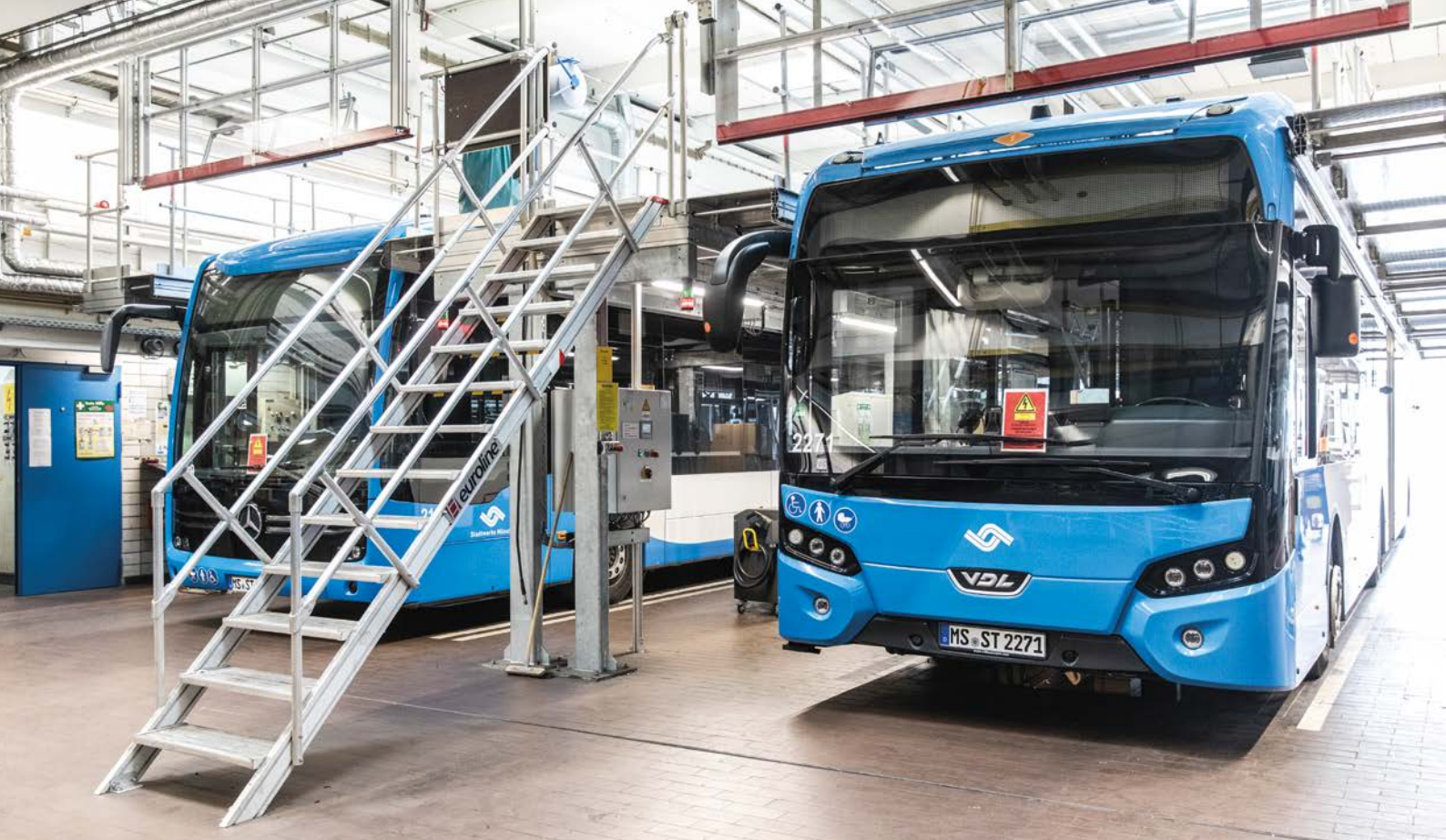
Abbildung 8: Busse im Dacharbeitsstand
