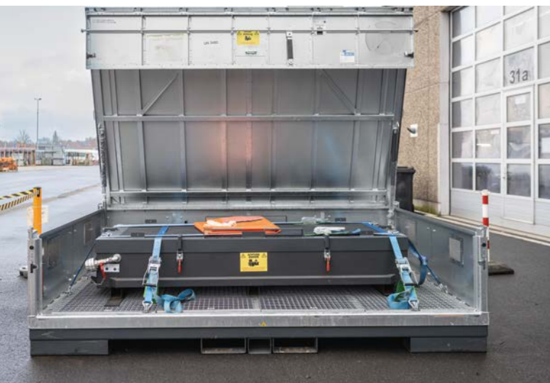
Abbildung 19: Gefahrstofflager für beschädigte (n. i. O.) HV-Batterien
