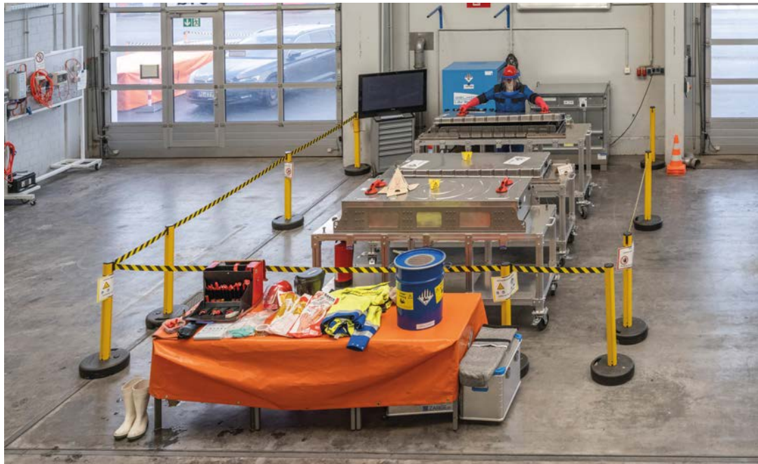
Abbildung 6: Arbeitsplatz für HV-Batterien
