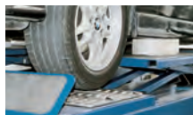
Integrierter Achsspieltester, Radfreiheber und zusätzliche Sicherung gegen Wegrollen
