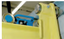
Sicherung des Grubenhebers gegen Kippen in Quer- und Längsrichtung
