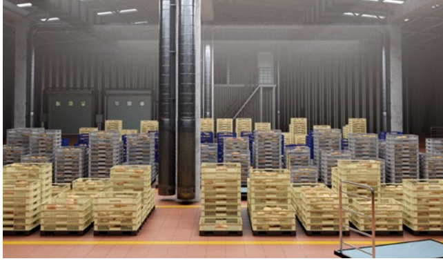
Abb. 2 Darstellung eines Backwarenverteilzentrums Gestapelte heiß-warme Backwaren geben Wärme und Feuchte an die Raumluft ab
