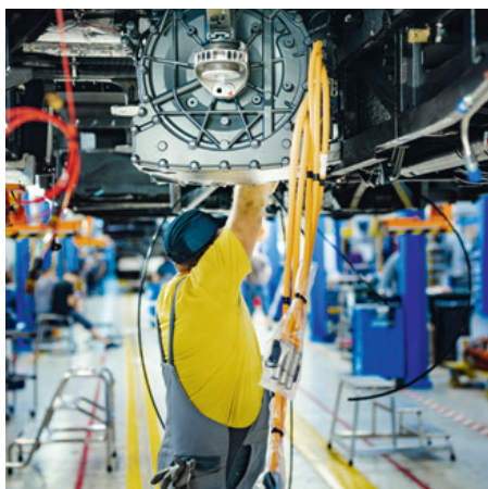
Auch unterhalb des Fahrzeugbodens verlaufen Hochvoltleitungen.
