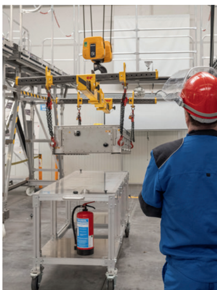
Fahrzeugwerkstätten benötigen eine moderne Ausstattung, hier ein Transportbehälter für Fahrzeugbatterien.
