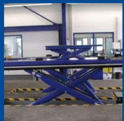
Aus Gründen des Prüfablaufes und des sicheren Umgangs haben sich für Kfz- Prüfanlagen Hebebühnen mit Fahrschienen als sinnvoll erwiesen. Häufig sind die Bühnen für die Prüftätigkeiten in Kfz-Prüfanlagen speziell ausgelegt, zum Beispiel mit schneller Hub- und Senkgeschwindigkeit, integriertem Achsspieltester sowie zusätzlichem Radfreiheber.
