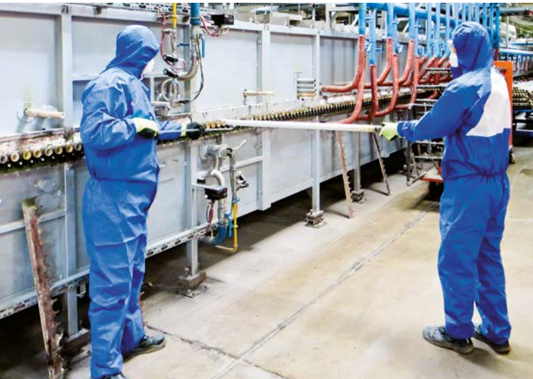
Abbildung 9: Rollenwechsel mit anschließendem Rollenstopfen
