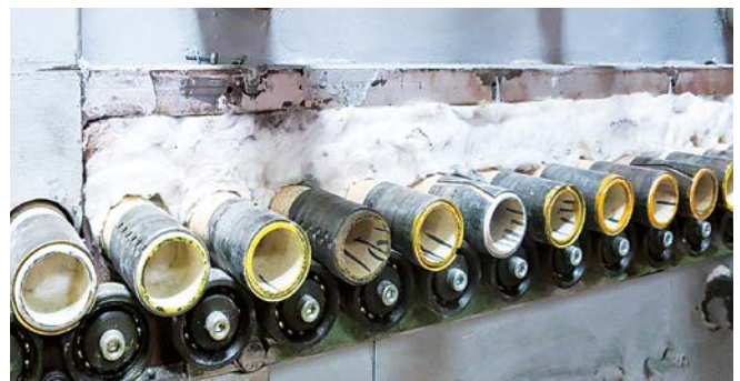
Abbildung 2: Abdichtung von Transportrollen bei Rollenöfen
