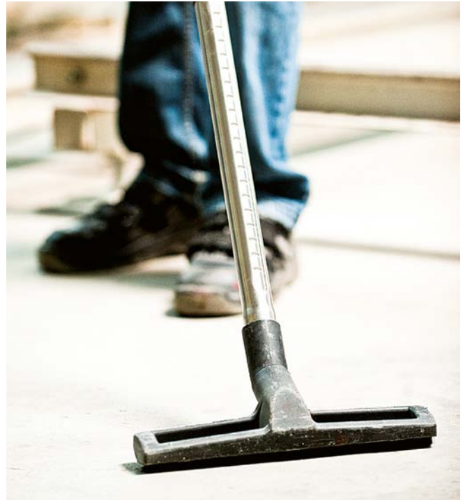
Abbildung 6: Aufnehmen von Feinstaub mit Entstauber/ Industriestaubsauger mindestens Staubklasse M
