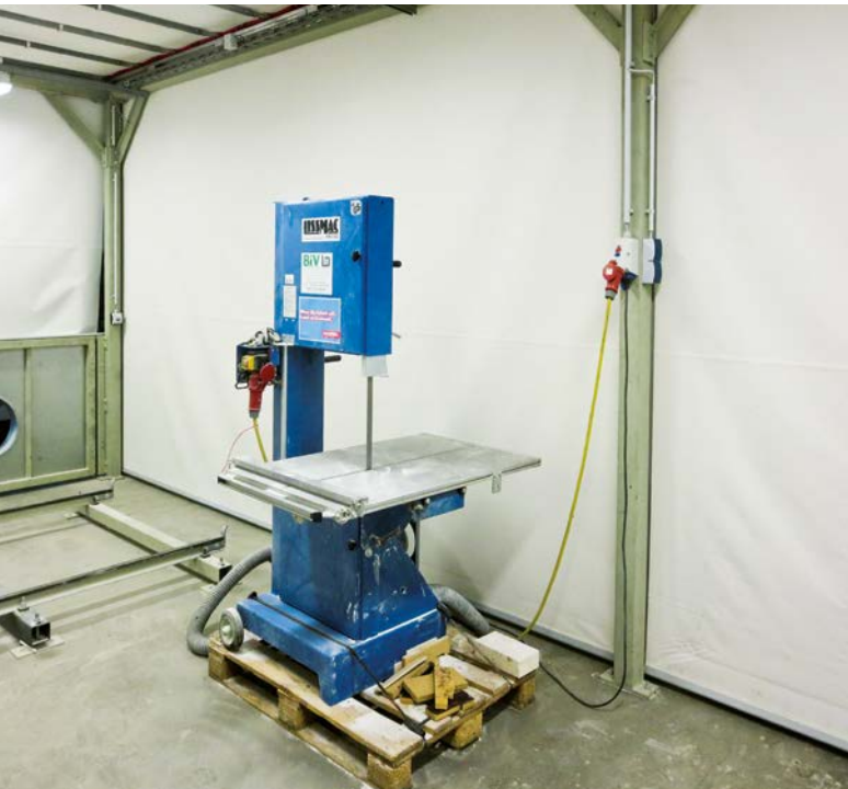
Abbildung 7: Absaugung und räumliche Abtrennung oder Einhausung
